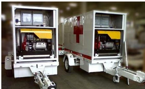
Передвижные станции для очистки питьевой воды предназначены для производства безопасной питьевой воды из большого количества традиционных и нетрадиционных водных источников в зонах с дефицитом водных ресурсов и/или с загрязненной водой.
