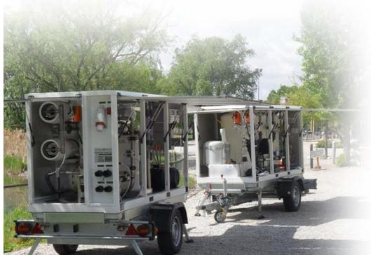
Передвижные станции для очистки питьевой воды являются простыми в использовании и многофункциональными, они обладают всем необходимым для установки на трейлер и перевозятся с одного места на другое, что делает их идеальными для различных аварийных ситуаций, таких как устранение последствий природных стихий или в лагерях для людей, оставшихся без крова
