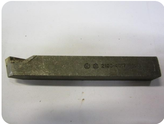
Резец токарный фасонный ГОСТ 18875-73
