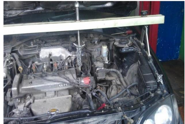
8. Вывернуть 2 болта крепления кронштейна к головке блока цилиндров и кронштейну опоры.
