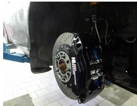
5. Снять подкрылок.
