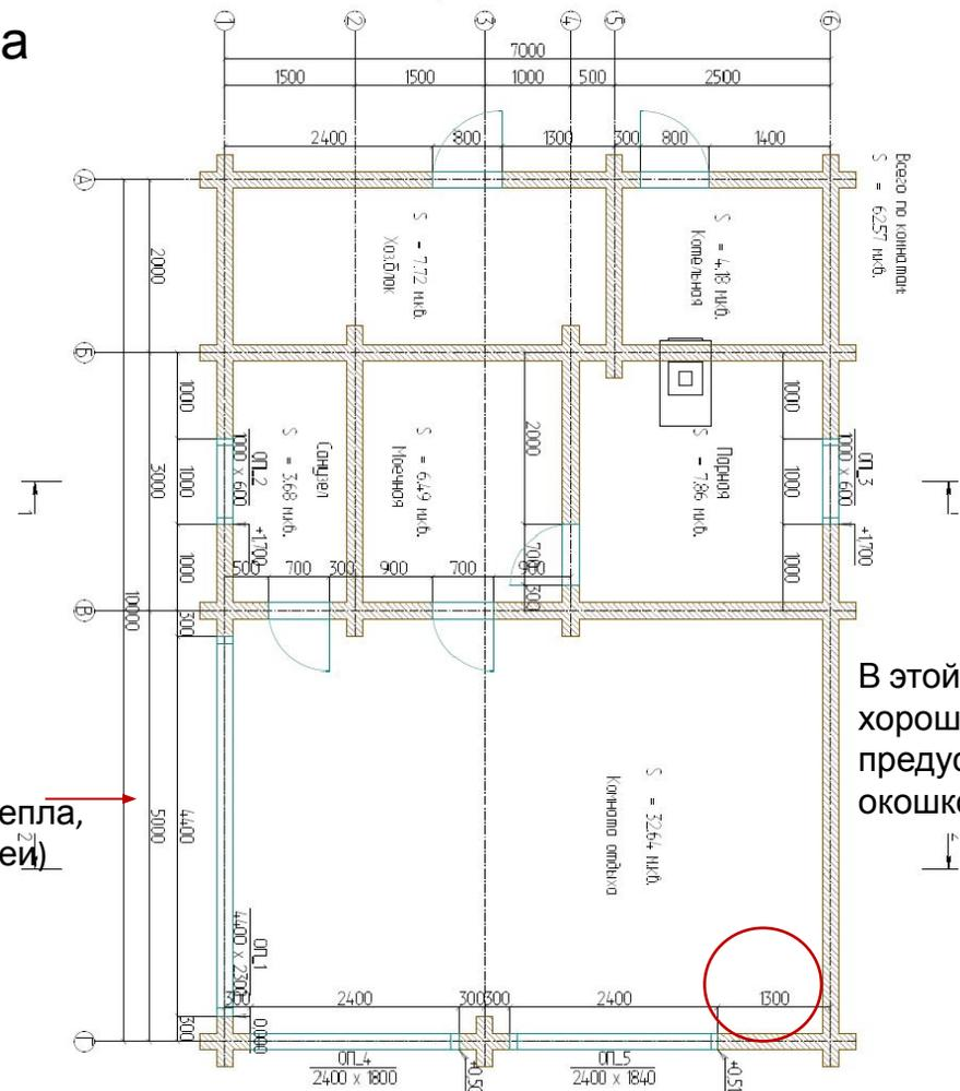
Панорамные окна, стенка от пола высотой 50 см (это важно для обеспечения тепла, думаем здесь повесить батареи)
