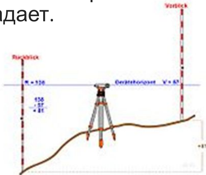
Рис. Геометрическое нивелирование методом «со середины»
