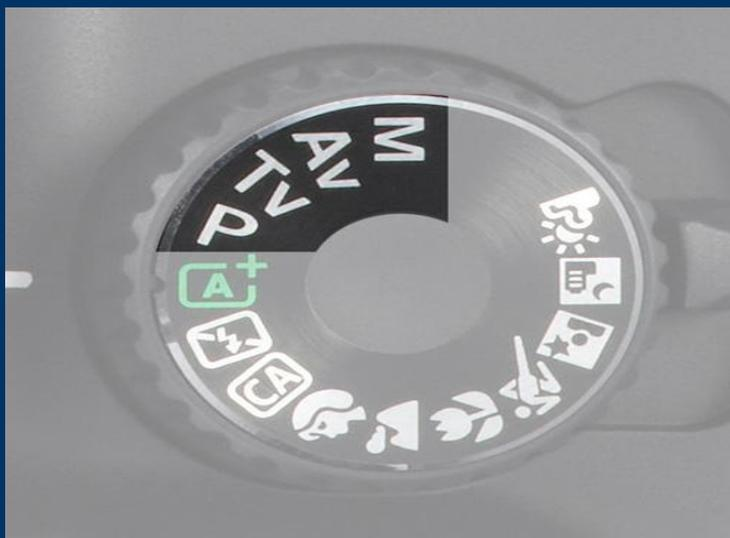
**Ручной режим M — позволяет управлять всеми параметрами камеры, диафрагмой, выдержкой, ИСО и многими другими.**
