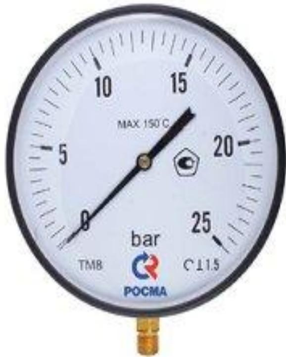
**Манометр** (от греч. *μανός* — редкий, *неплотный* и ...метр) прибор для измерений давления жидкостей и газов.
