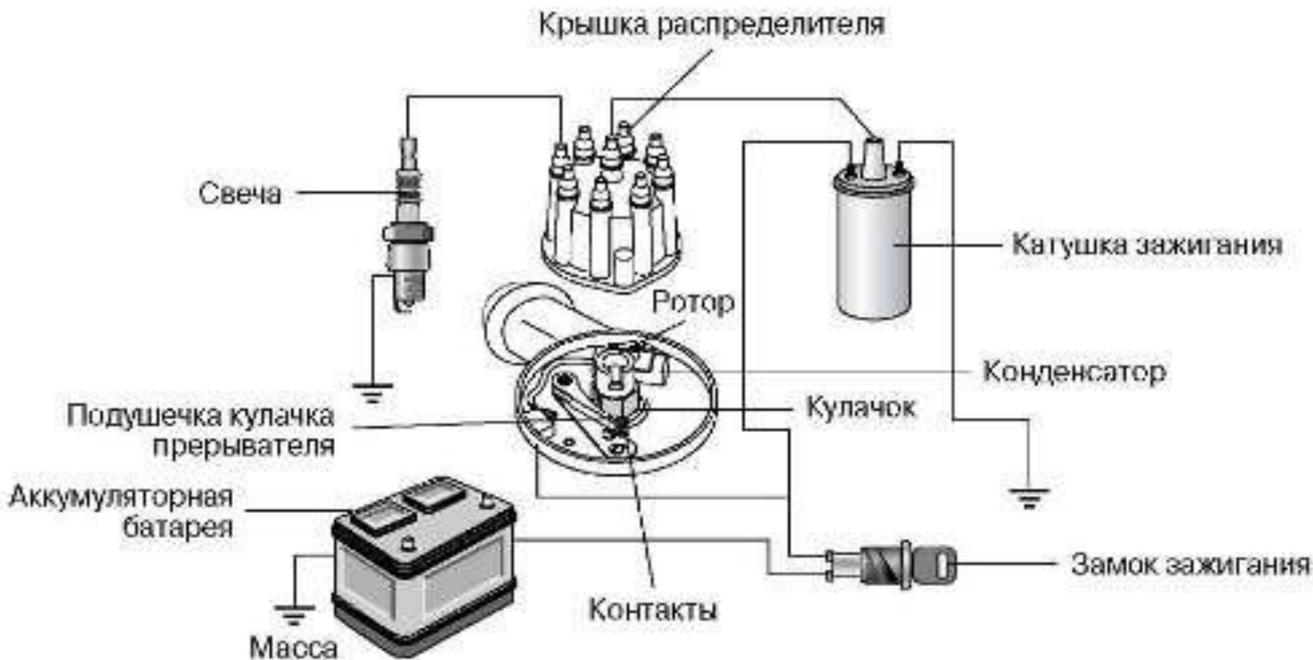
Рис. 5.8. Схема обычной незлектронной системы зажигания
