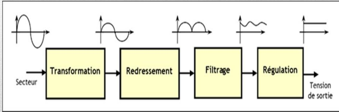
Schéma fonctionnel de l'alimentation d'un objet technique
