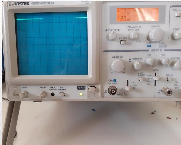
Figure 2 : Tension filtrée par condensateur
