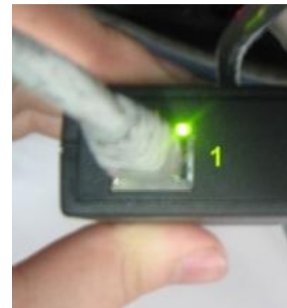
При наличии сигнала LED индикатор обычно светится или мигает
