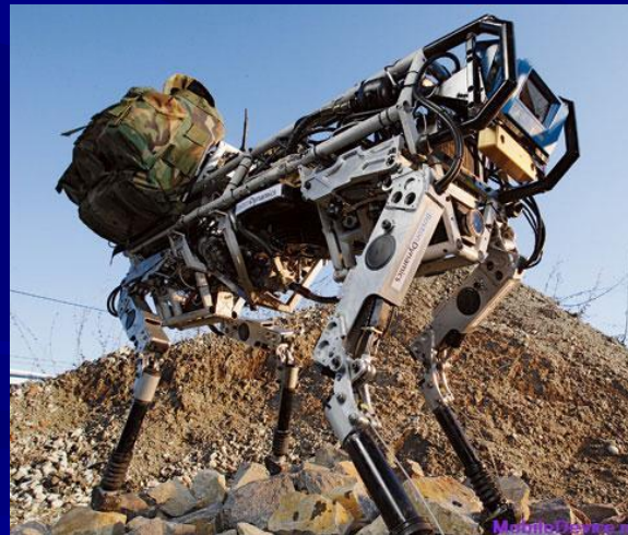
Транспортный робот BigDog (Boston Dynamics)
