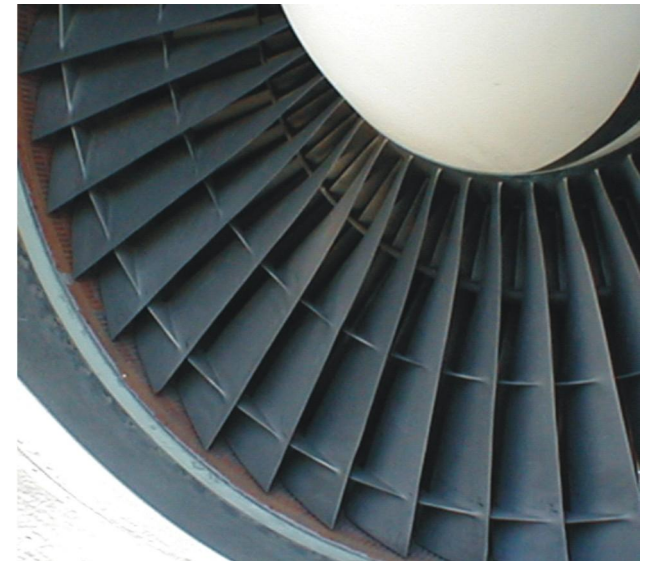
лопатки с антивибрационными полками на двух уровнях.
