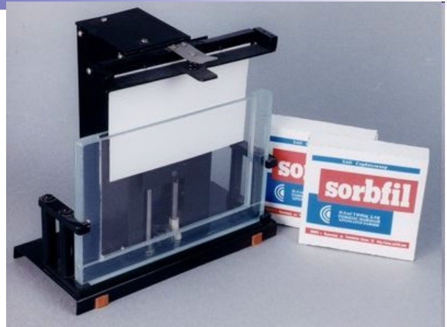
Прилад для обробки пластин рідиною для проявлення методом занурення
