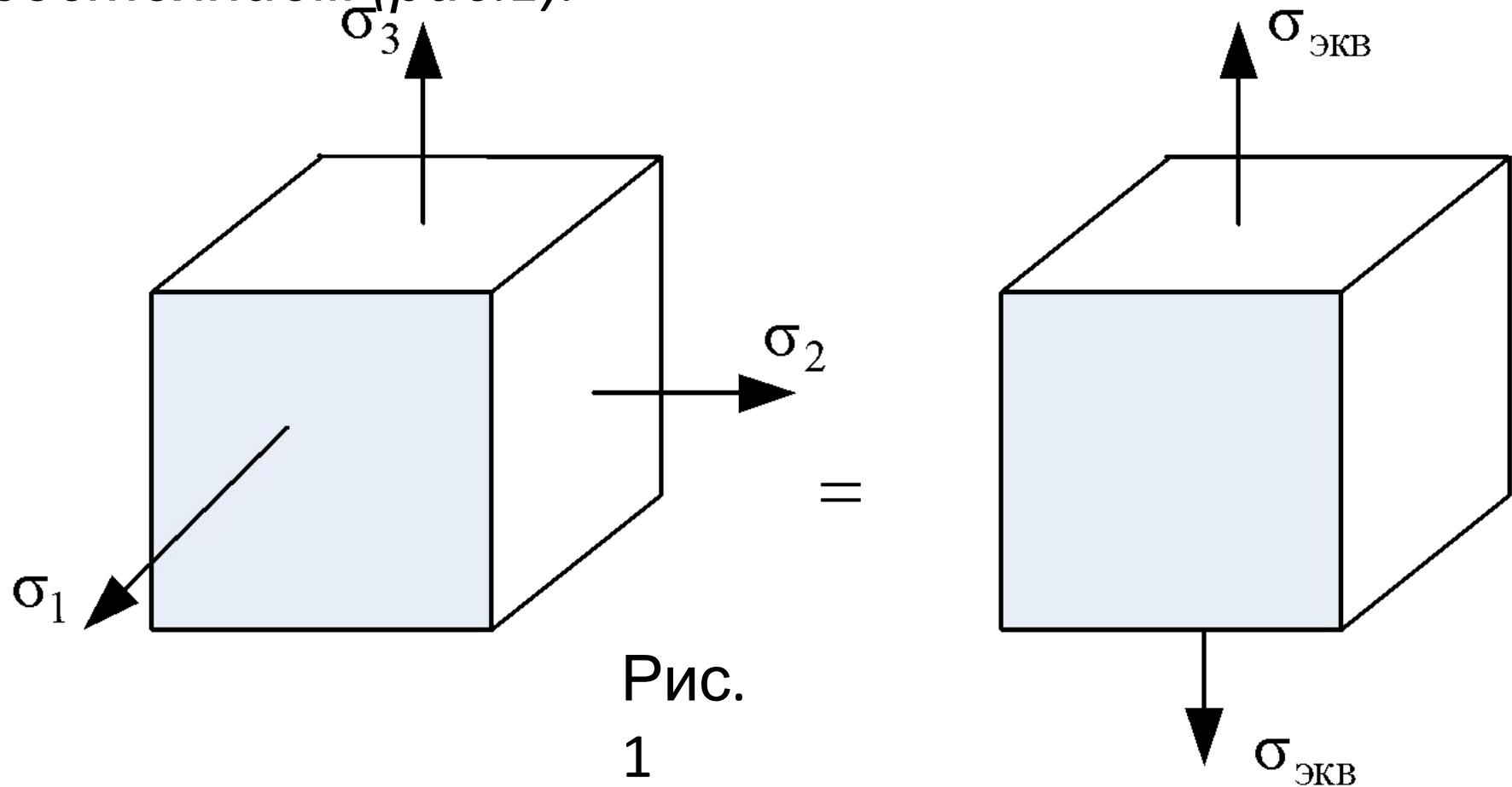
Вводя понятие эквивалентного напряжения, мы сводим расчет на прочность в сложном напряженном состоянии к расчету на обычное растяжение. Действительно, коэффициент запаса при растяжении определяется, как обычно, следующим образом:
