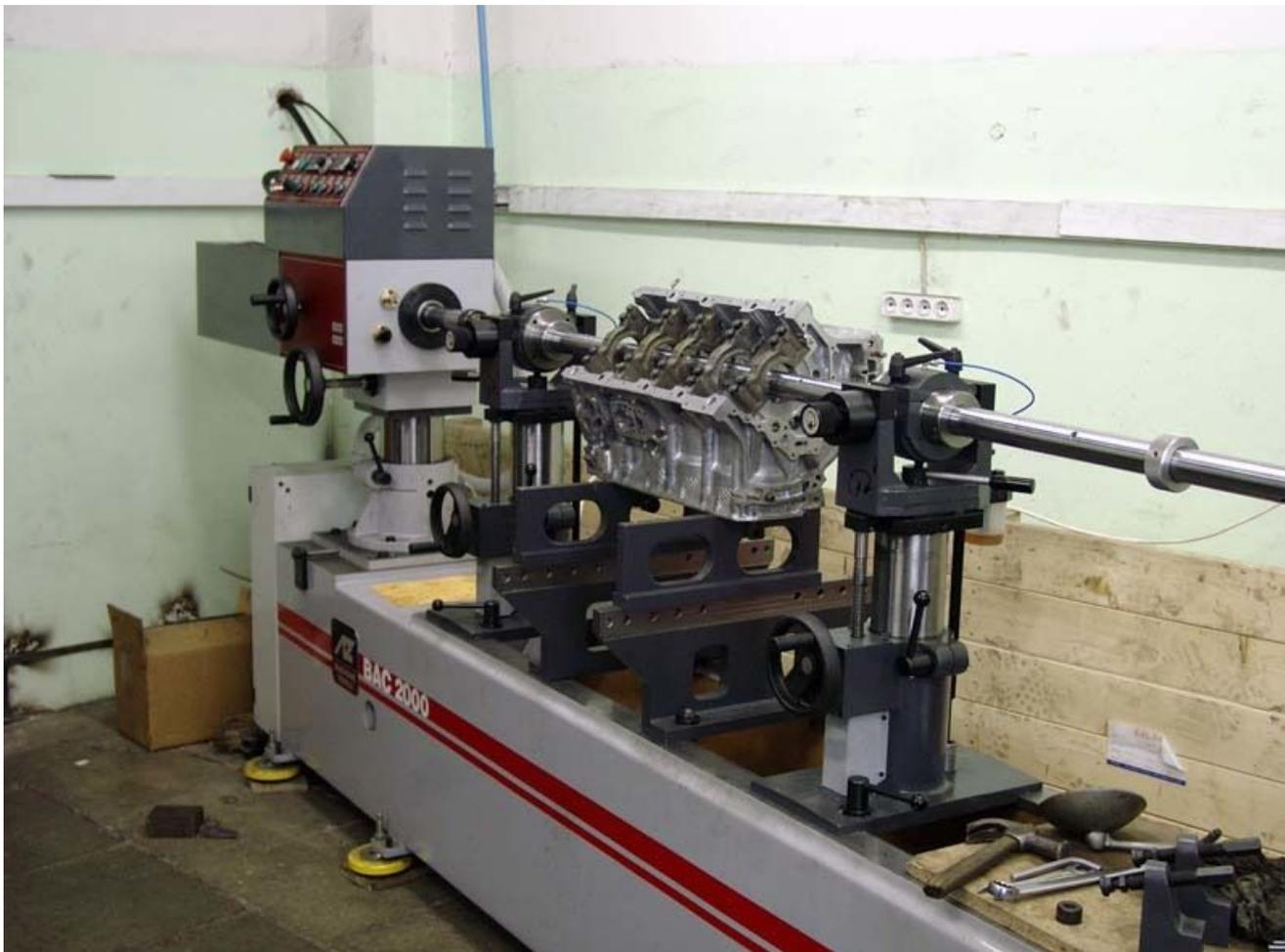
Растачивание нескольких отверстий с помощью борштанги с передним направлением
