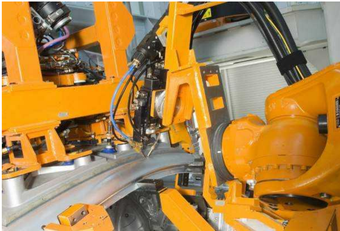
Лазерная сварка крыши и боковины на производстве
