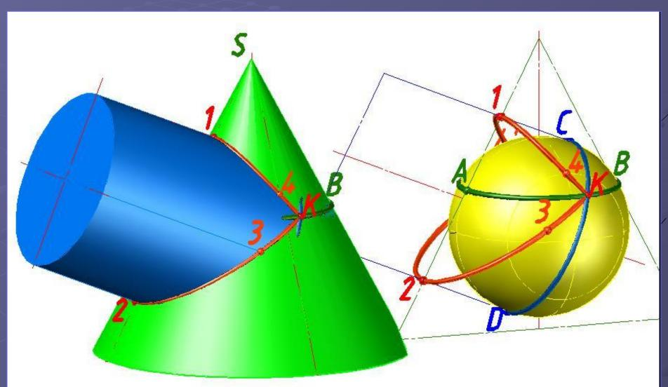
Если две поверхности второго порядка имеют касание в двух точках, то линия их пересечения распадается на две плоские кривые второго порядка, плоскости которых проходят через прямую, соединяющую точки касания (1 и 2).
