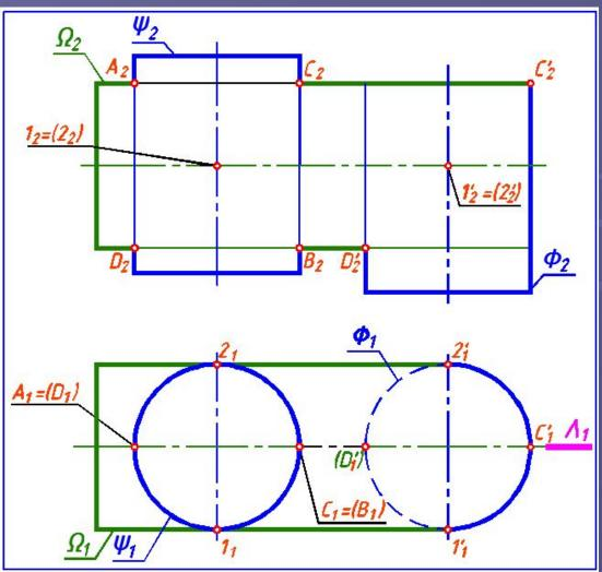
2. Линия пересечения цилиндров О и — две кривые второго порядка (эплипса), плоскости которых проходят через прямую, соединяющую точки касания 1, 2.
