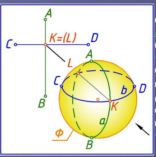
Сфера 🥠 касается конуса 🦞 по окружности ((AB). Сфера 🐠 касается цилиндра  $\Psi$  по окружности b(CD). Определяем отрезок КL, в пересечении окружностей 🧧 (AB) и **b**(CD). Окружности 🧧 и 👂 на П<sub>2</sub> проецируются в отрезки 🖊 и CD, а отрезок KL – в точку.
