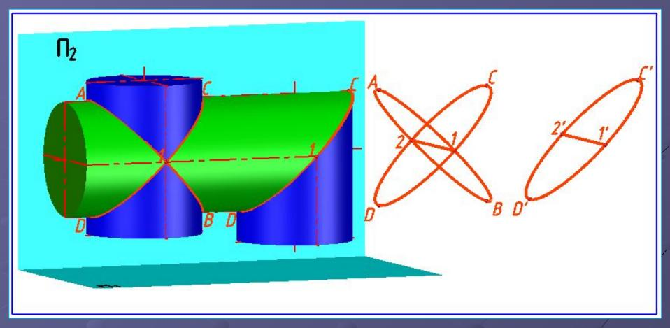
Теорема 2. Если две поверхности второго порядка имеют касание в двух точках, то линия их пересечения распадается на две кривые второго порядка, плоскости которых проходят через прямую, соединяющую точки касания (1 и 2).
