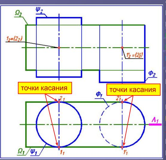
Задача. Построить проекции линий пересечения горизонтального цилиндра  $(\Omega)$  и вертикальных цилиндров  $(\Psi)$  и  $(\Phi)$ . Определить видимость.
