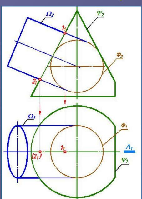
3. Опорные точки. Экстремальные (они же очерковые относительно  $\Pi_2$ ) точки 1 и 2 построены с помощью общей плоскости симметрии Л (очерк – ось).
