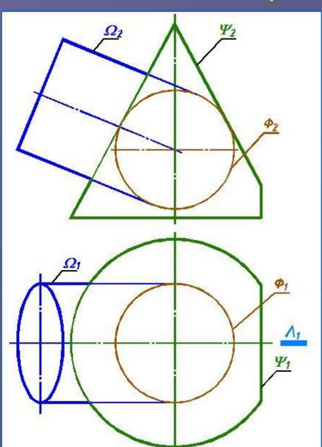
Задача. Построить проекции линии пересечения поверхностей конуса (Ψ) и цилиндра(Ω). Определить видимость.
