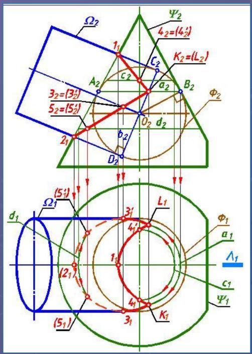
5) Соединив полученные точки плавной кривой с учетом видимости, получим горизонтальную проекцию линии пересечения заданных поверхностей. Точки 3, 3" – точки смены видимости. Доводим очерк цилиндра **О** до этих точек.
