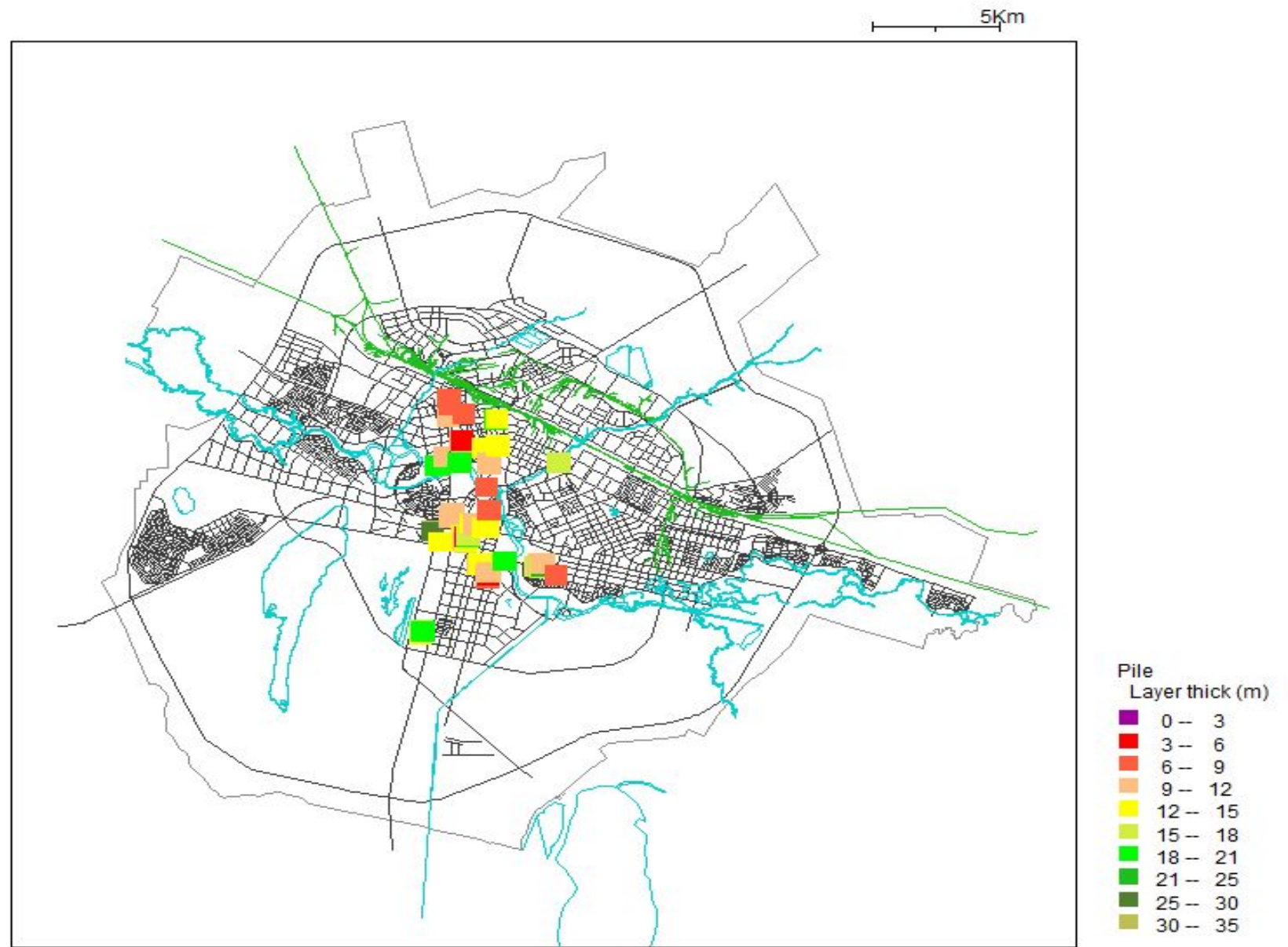
Карта районирования по оптимизации длин буронабивных свай
