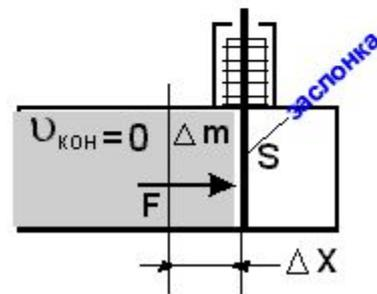
Рассмотрим зону  $\Delta x$  примыкающую к заслонке. Именно эта масса жидкости условно останавливается "почти мгновенно" после перекрытия трубопровода. Что происходит в остальной массе жидкости, об этом позже.
