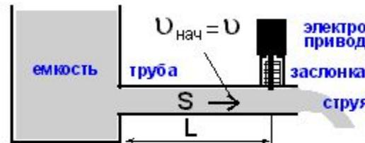
Гидравлический удар возникает при резком, "почти мгновенном", перекрытии трубопровода, по которому движется жидкость:
