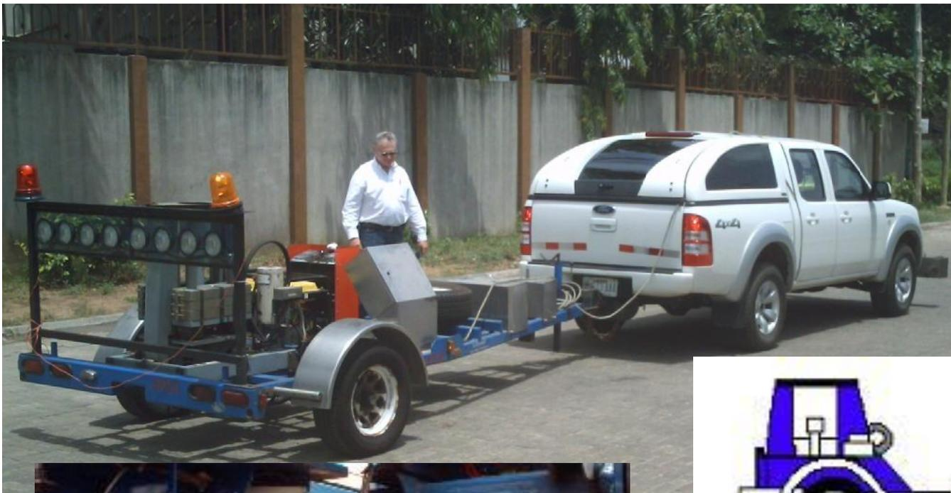
**ДЕФЛЕКТОМЕТР ПАДАЮЩЕГО ГРУЗА (ДПГ):** технические характеристики, определенные в ASTM D4694
