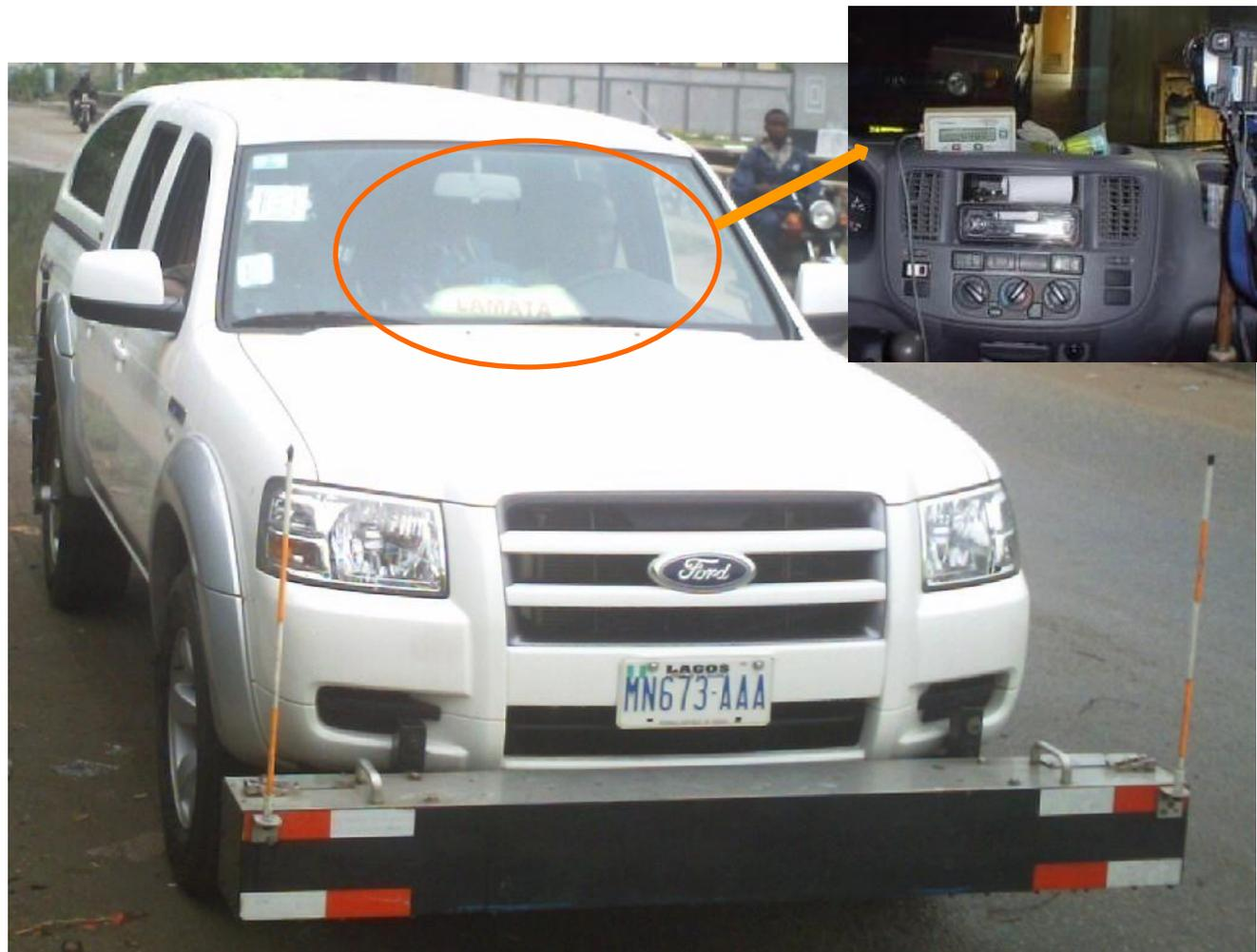
**Профилировщик дорожного покрытия: калиброванное оборудование (требования точности и погрешности 1 класса, определенные в стандарте ASTM 950)**
