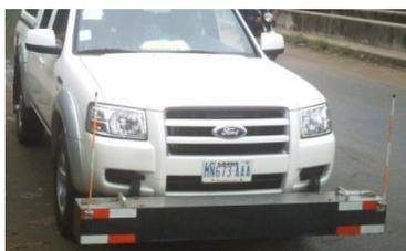
**Профилировщик дорожного покрытия: калиброванное оборудование. Высокоскоростные инерционные профилировщики (требования точности и погрешности 1 класса, определенные в стандарте ASTM 950)**
