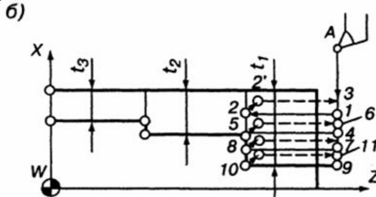
В схеме **по циклам вертикалей** припуск удаляют последовательно в каждой области. При такой схеме сначала удаляют припуск  $t_1$  (рис. б), потом  $t_2$ , потом  $t_3$ . Траектория резца проходит по следующим точкам: А, 1, 2, отход на 0,5 мм в точку 2' и на ускоренном ходу в точки 3, 4. Далее резец движется по точкам: 5, 6, 7, 8, 9, 10, 11, А.
