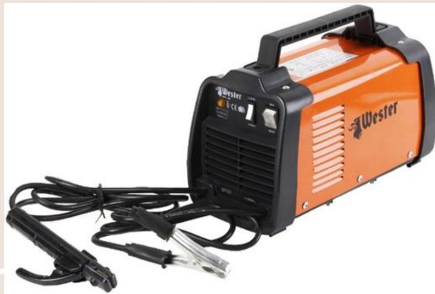
Сварочный трансформатор WESTER ARC 130
