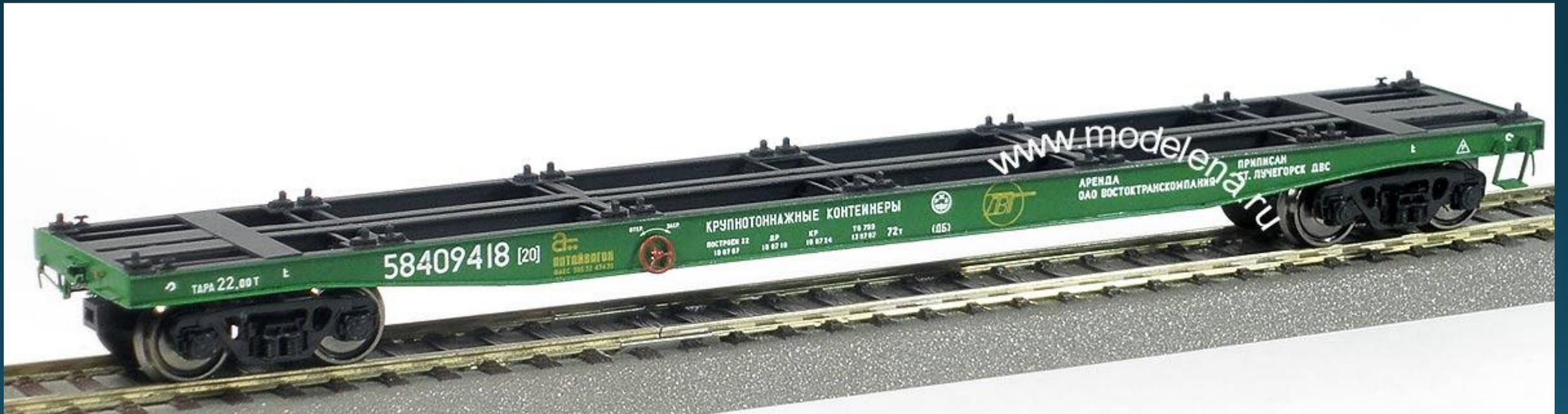
**Фитинговая платформа** — специализированная платформа, предназначенная для перевозки крупнотоннажных контейнеров и оборудованная специализированными узлами для их крепления — фитинговыми упорами (этот упор входит в замок контейнера).
