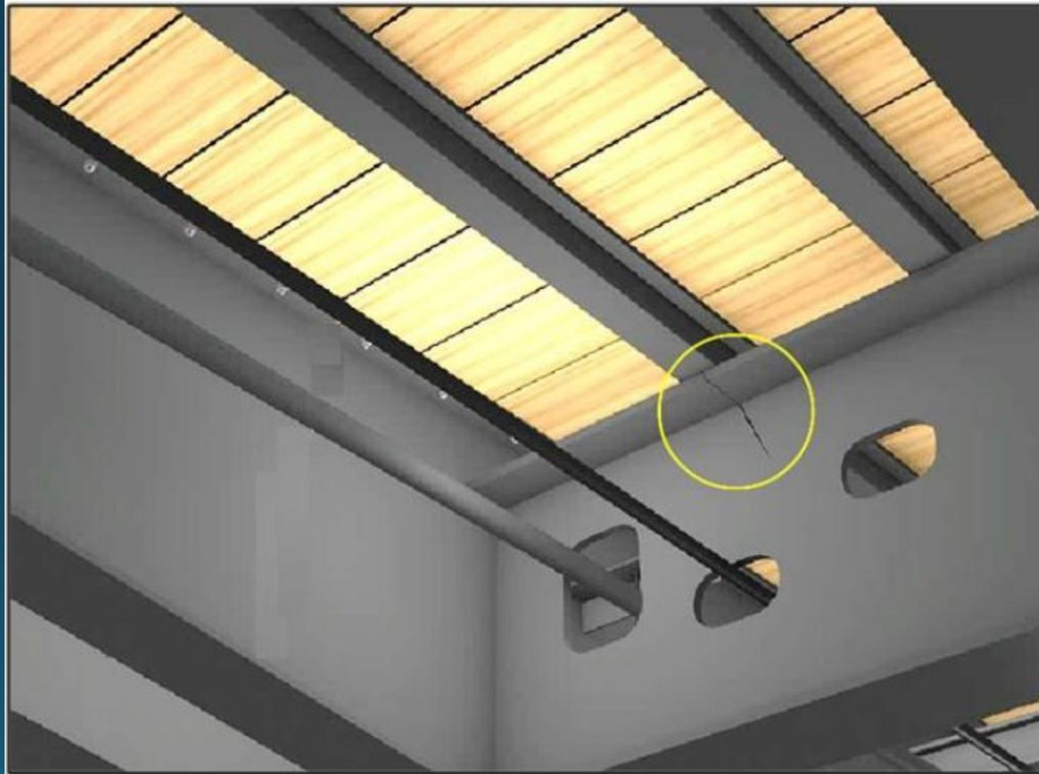
8. Трещины или разрывы верхнего или вертикального листа шкворневой балки рамы.
