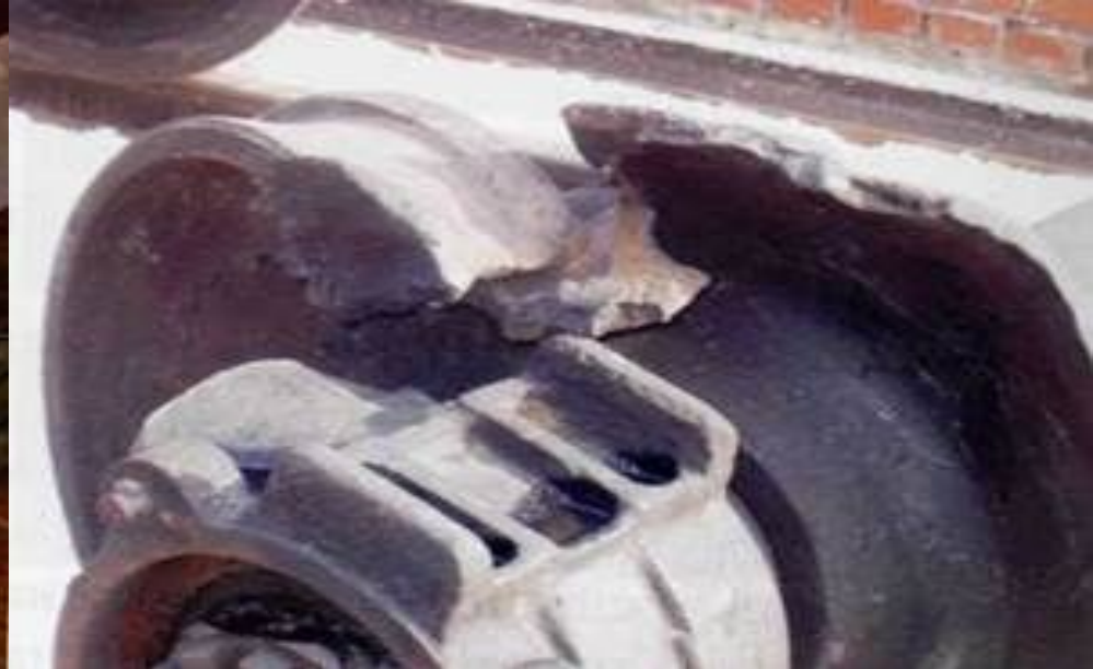
Излом колеса грузового вагона
