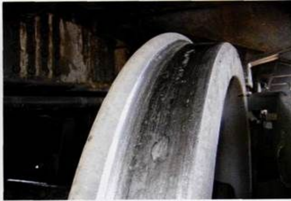
След термического воздействия
