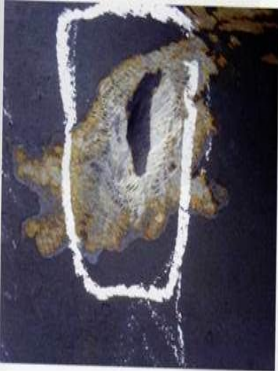
Забойна диска колеса с трещиной
