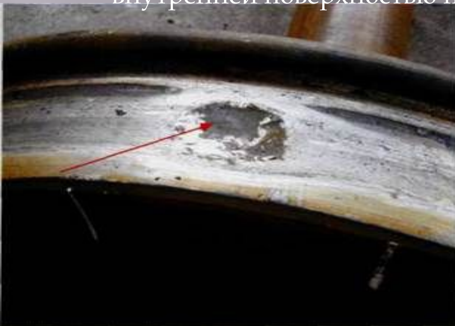
Выщербина с трещиной, идущей в глубь металла
