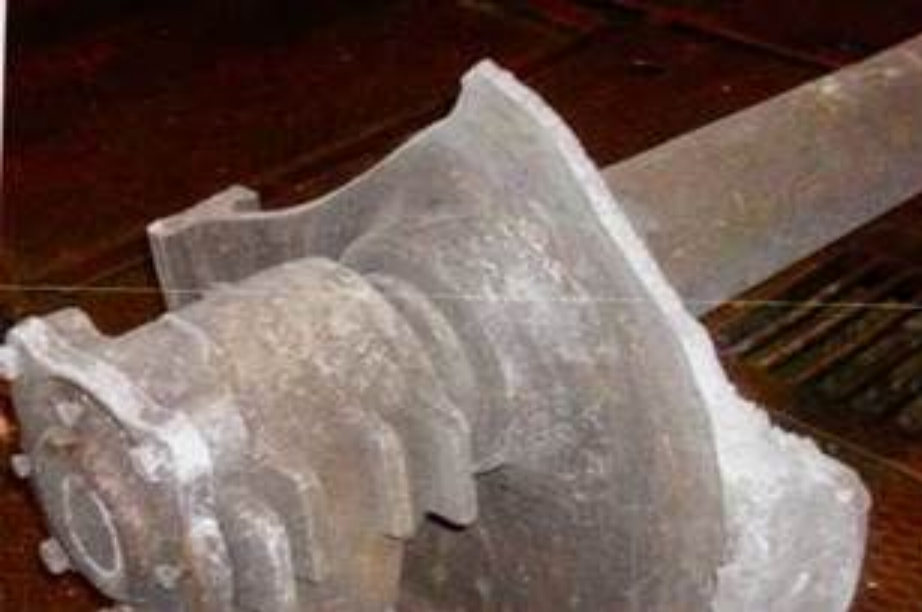
Излом колеса грузового вагона
