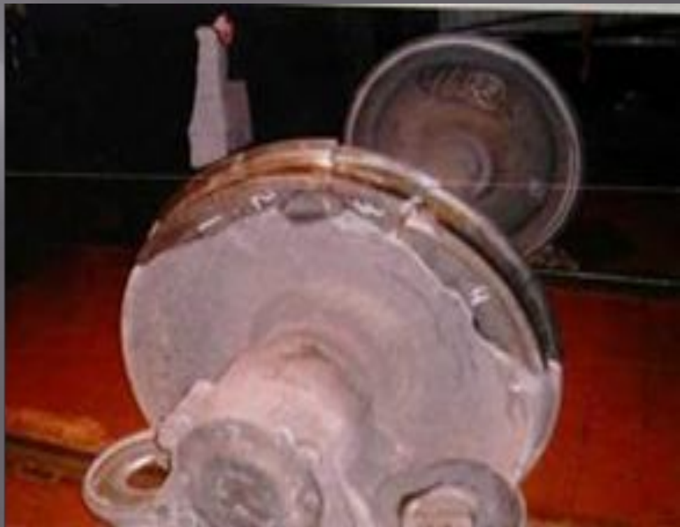
Излом колеса тележки грузового и рефрижераторного вагонов
