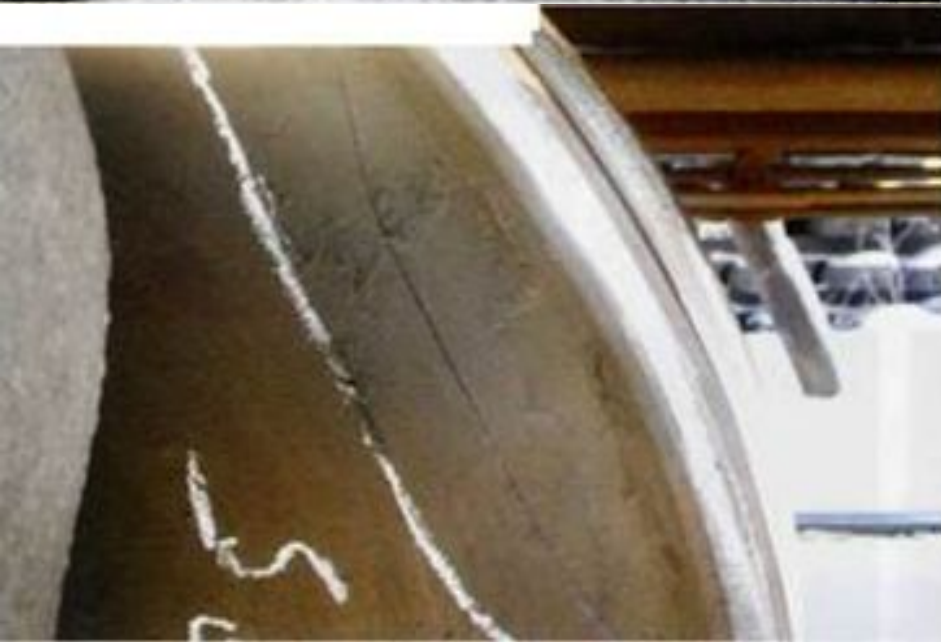
Трещина диска колеса в прибородной зоне
