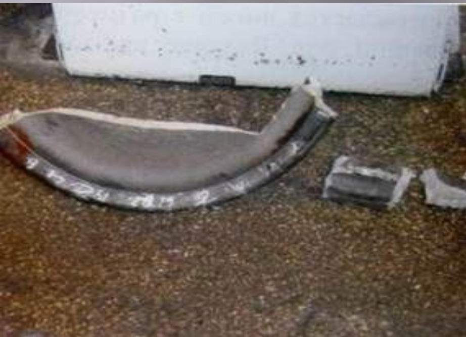
Излом колеса грузового вагона (фрагменты)
