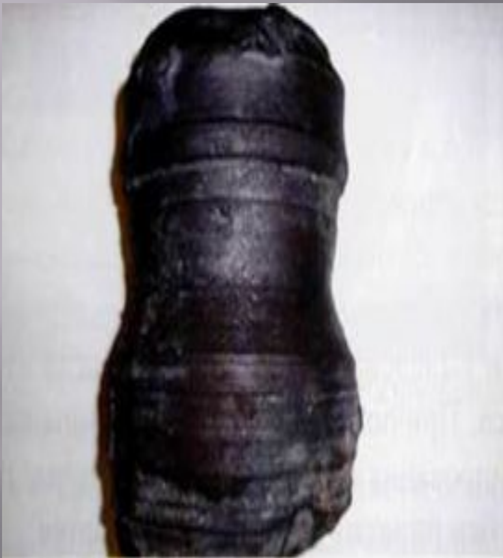
Излом шейки оси от перегрева
