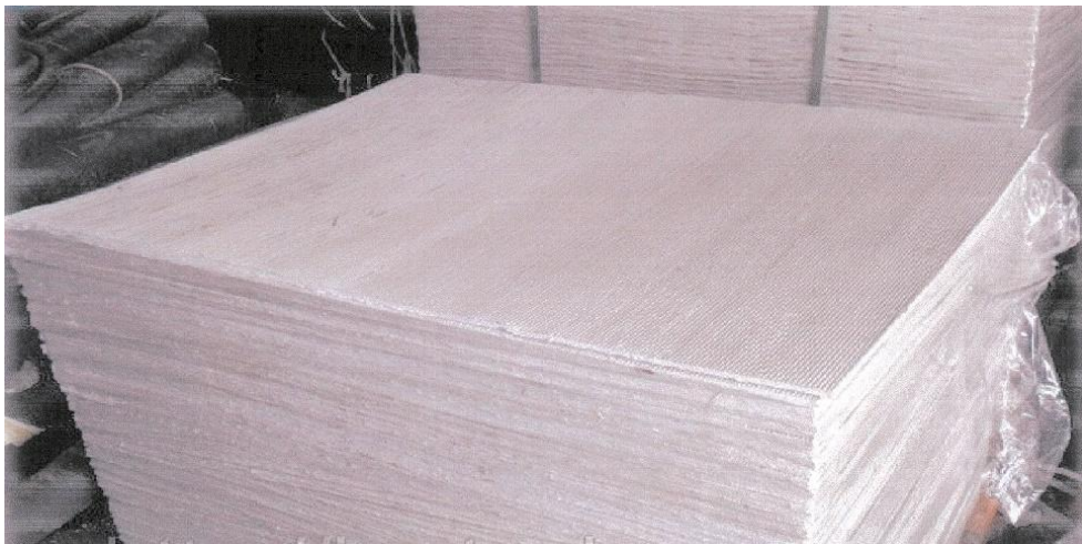
Асбестовый картон, для теплоизоляции трубопроводов с температурой эксплуатации до 500 °С и защиты деревянных и легковоспламеняющихся предметов.
