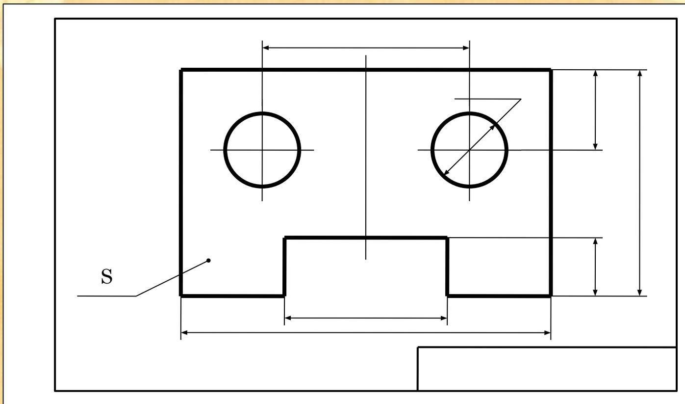
Обводка: окружности, горизонтальные линии, вертикальные, наклонные. Заполнение основной надписи.
