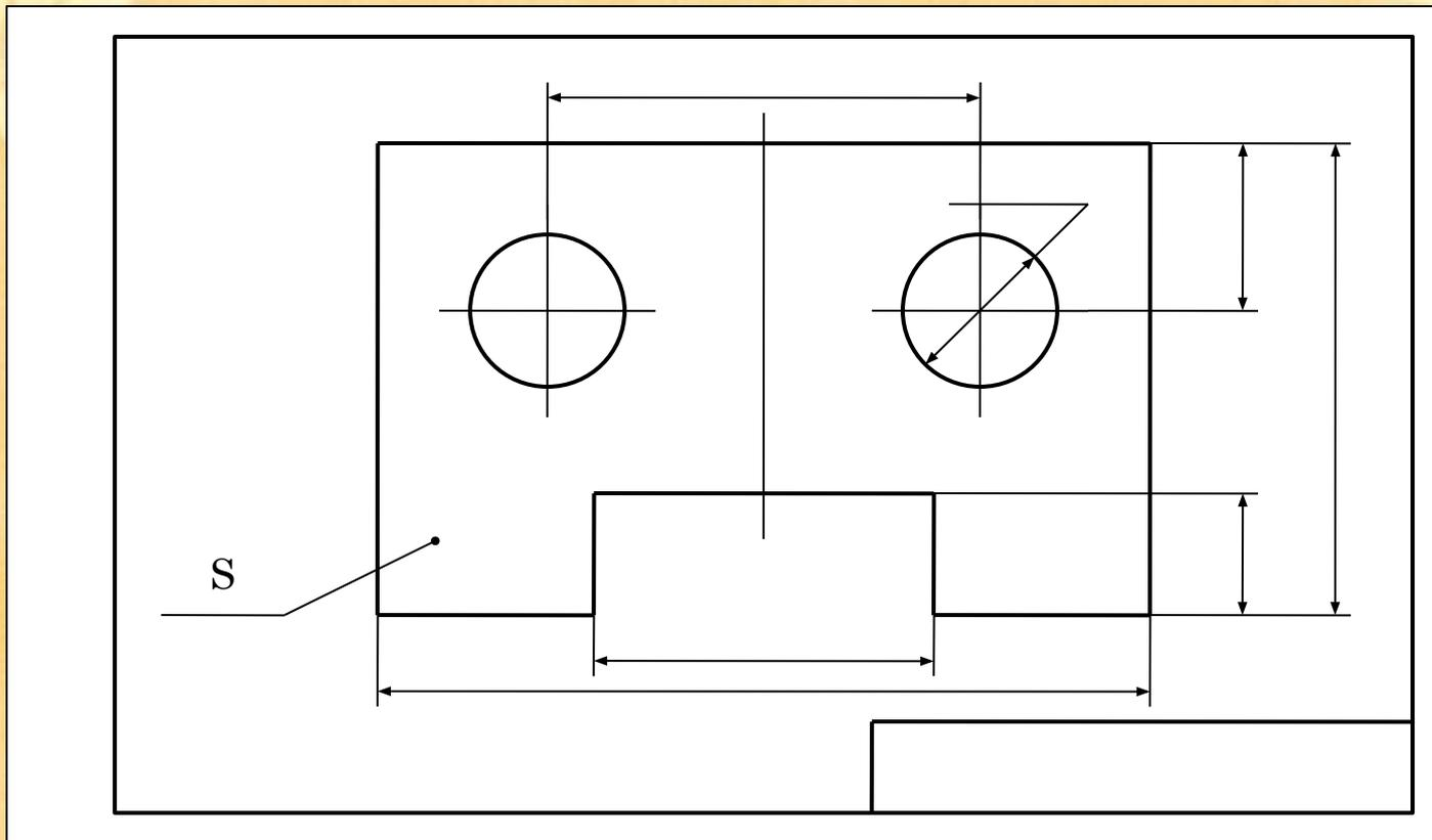
**8. Нанесение размеров по длине, по высоте и толщине.**
