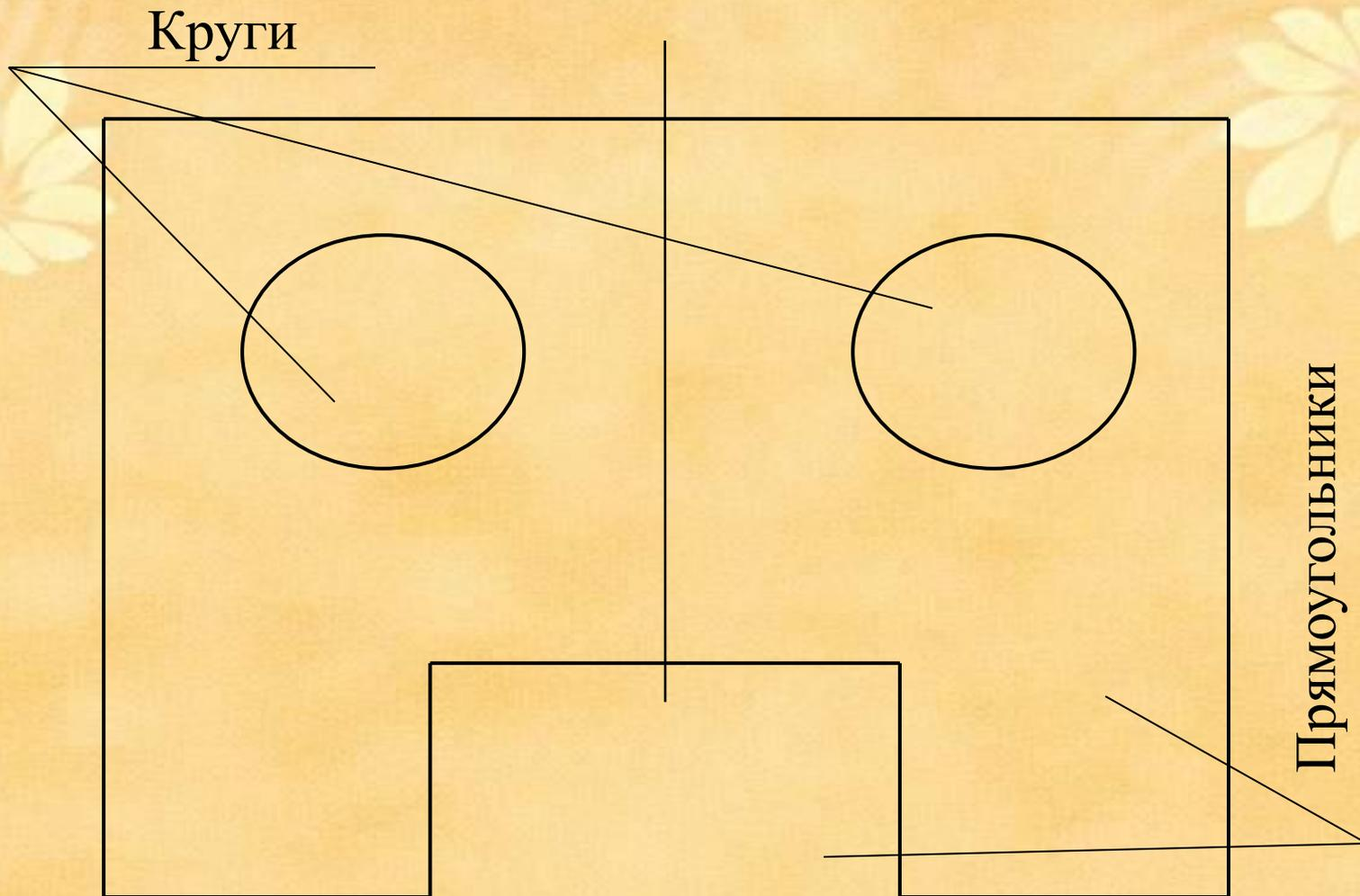
**2. Установление главного вида, анализ его графического состава, например: прямоугольник, имеет прямоугольные вырезы, в центре – круг. Изображение симметрично относительно одной оси симметрии.**
