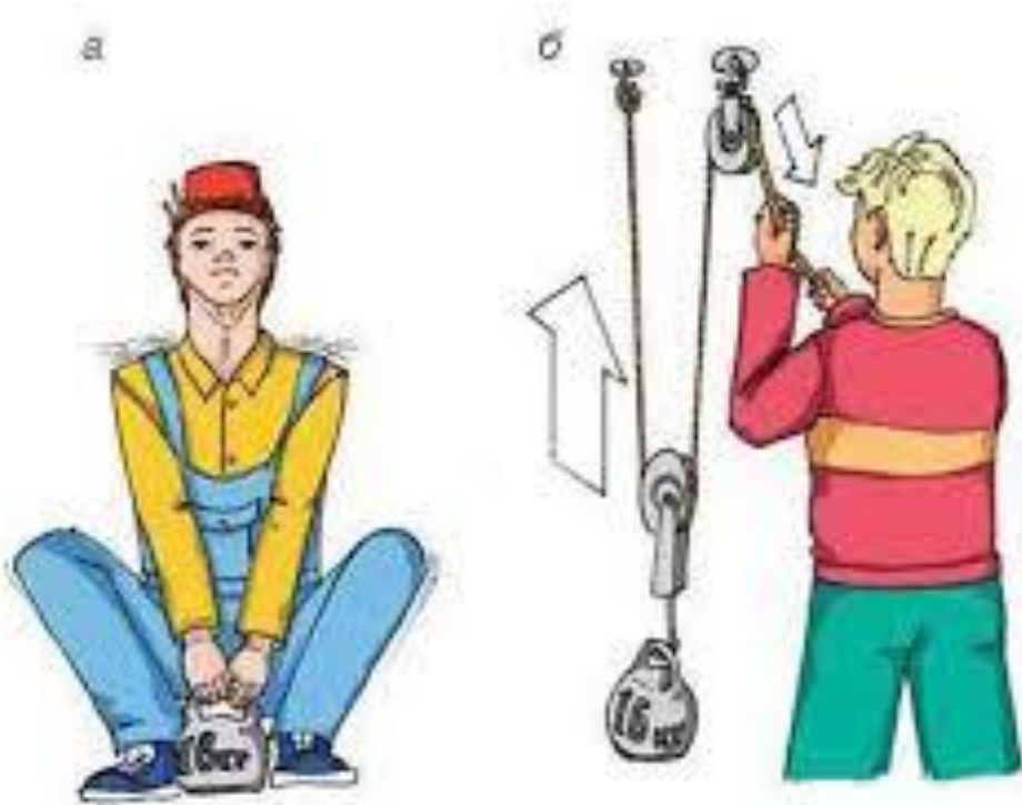
Мал. 120. Використання блока для піднімання вантажу.
