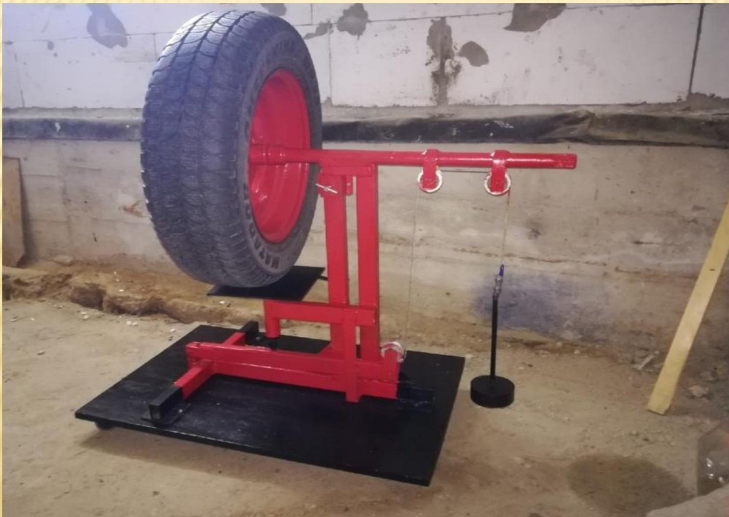
Реальная часть представляет собой модернизацию стенда по определению жесткостной характеристики шины. Данный стенд предназначен для использования в образовательном процессе при выполнении лабораторной работы по учебной дисциплине «Испытание автомобилей», а так же при изучении других учебных дисциплин.
