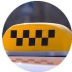
Опознавательный фонарь, установленный на крыше автомобиля
