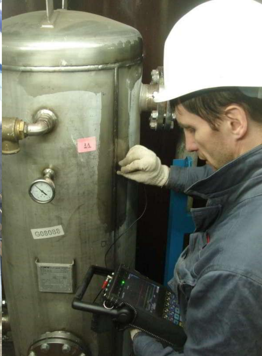
Рис. 1, 2, 3 Неразрушающий контроль качества сварного шва
