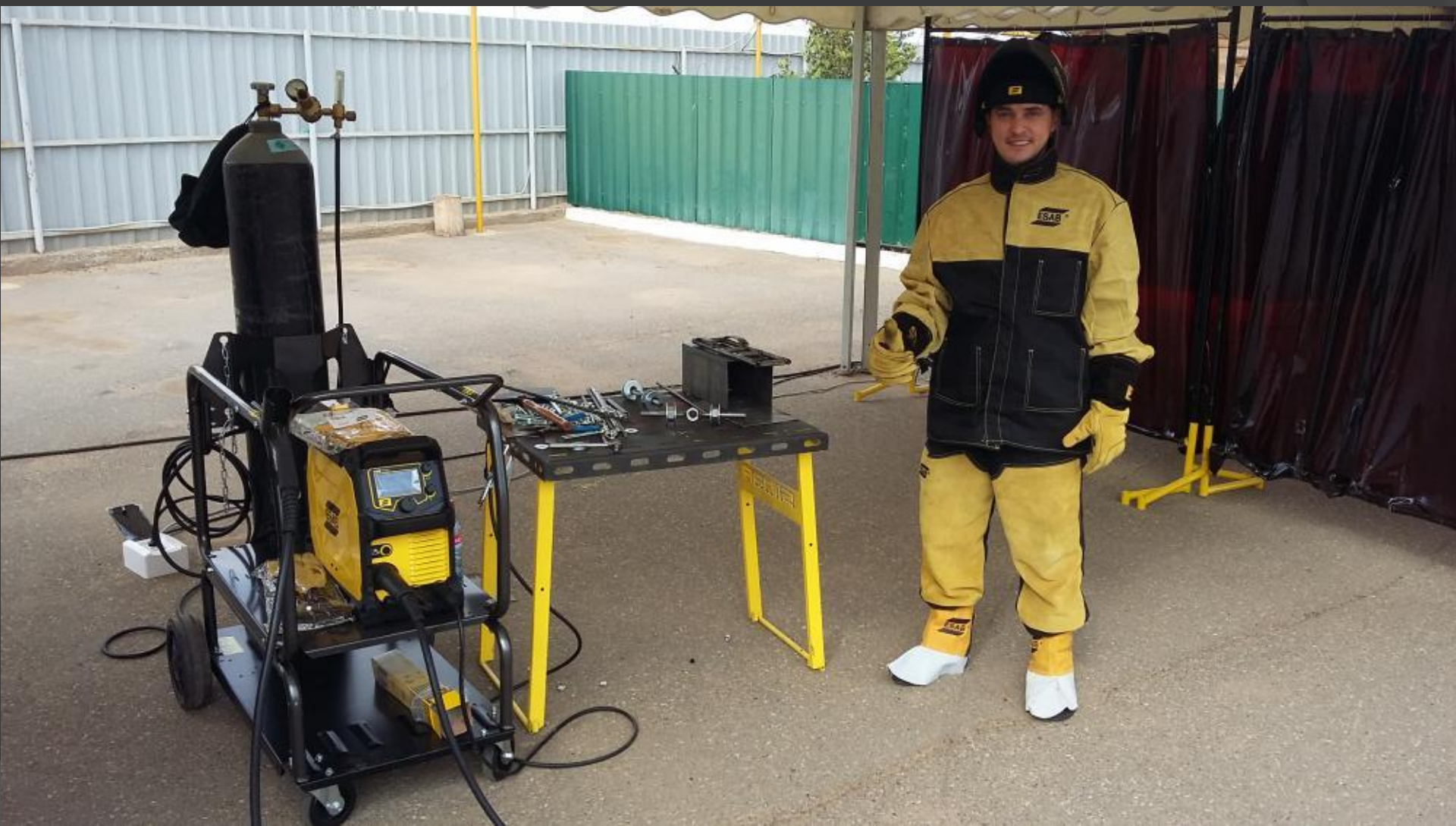
Рис.1 Передвижной сварочный пост
