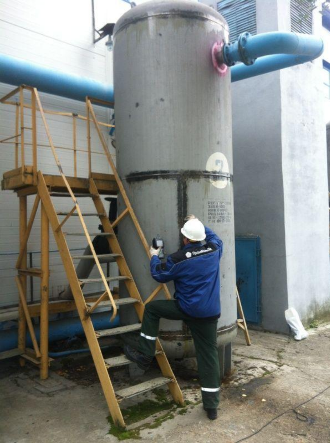
Рис. 1, 2, 3 Неразрушающий контроль качества сварного шва
