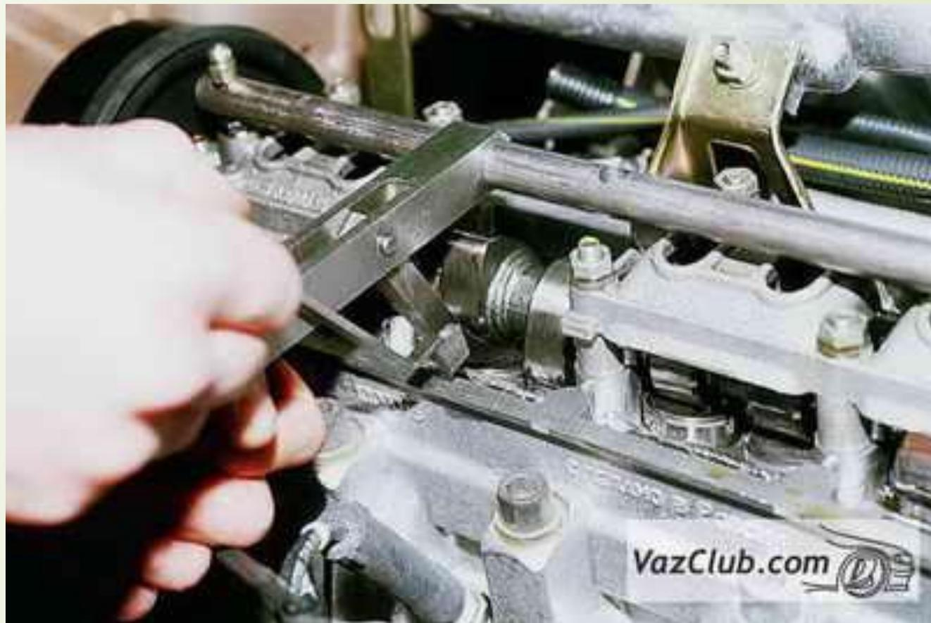
Утапливание толкателей клапанов при замене регулировочной шайбы
