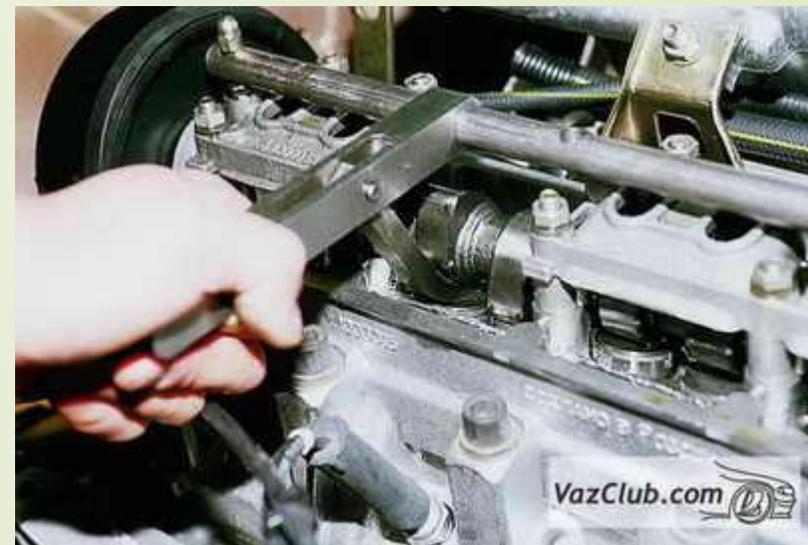
Разворачиваем толкатель так, чтобы прорезь в его верхней части была обращена вперед (по ходу).
