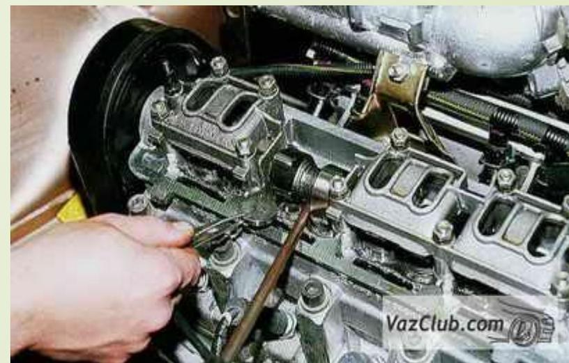
**Последовательно поворачивая коленчатый вал на пол-оборота, регулируем зазоры остальных клапанов ваз 2112 в последовательности, указанной в таблице:**
