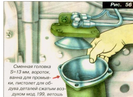
Рис. 56. Промыть фильтр грубой очистки топлива.
