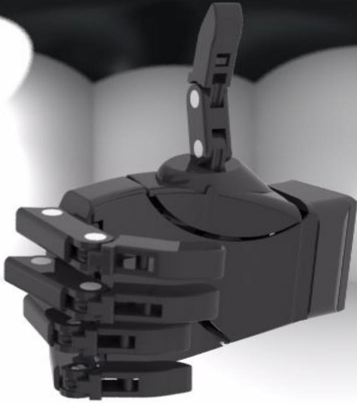
Все детали выполнены с легкой возможностью замены при поломке, что позволяет экономить на первом и последующем производстве деталей. Внутри сборка является полой для уменьшения веса при использовании.
