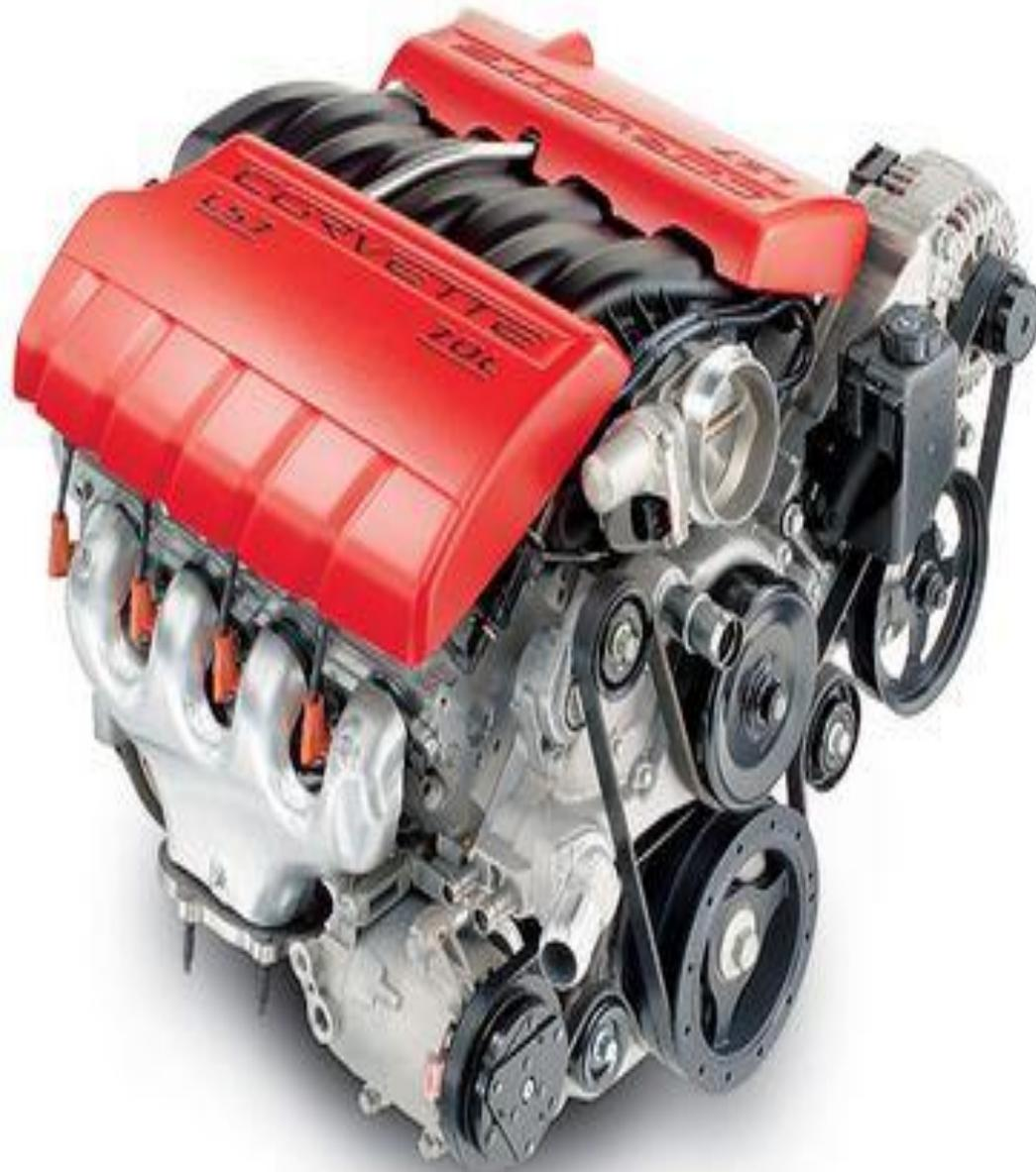
На большинстве современных автомобилей установлены **поршневые двигатели внутреннего сгорания (ДВС)**, в которых часть энергии, выделяющейся при сгорании топлива в цилиндре, преобразуется в механическую работу вращения коленчатого вала
