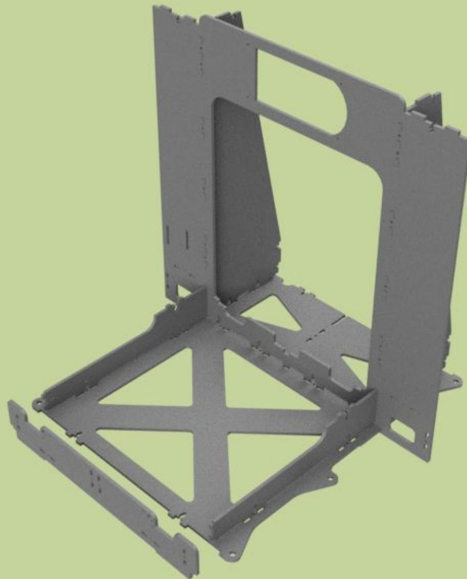
4. Устанавливаем на нижнее основание пластину крепления мотора Y, предварительно вставив в паз гайку М3.
