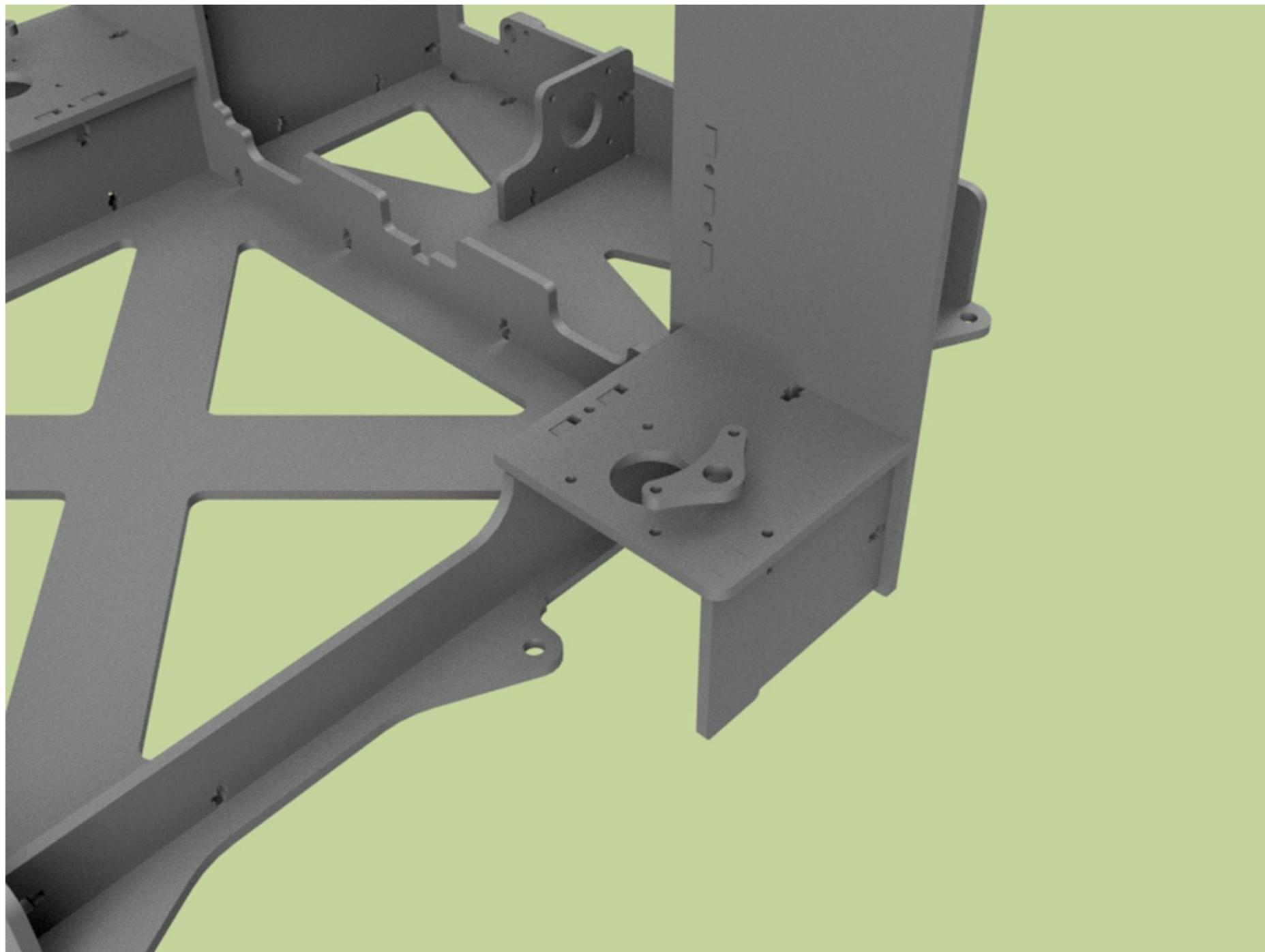
7. Устанавливаем верхние пластины. Вставляем направляющие валы Z вместе с осью X в сборе из 3d принтера Anet A6 . Фиксируем валы стопорными пластинками, так же можно использовать анаэробный резьбовой герметик.
