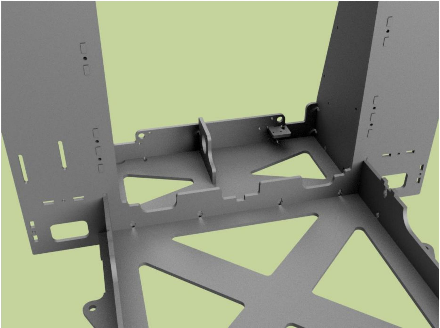
6. Устанавливаем крепление моторов Z. Сами моторы крепить винтами М3 8 мм из прилагаемого к набору крепежа. Фиксаторы направляющих валов Z крепить вместе с моторами винтами М3 12мм.
