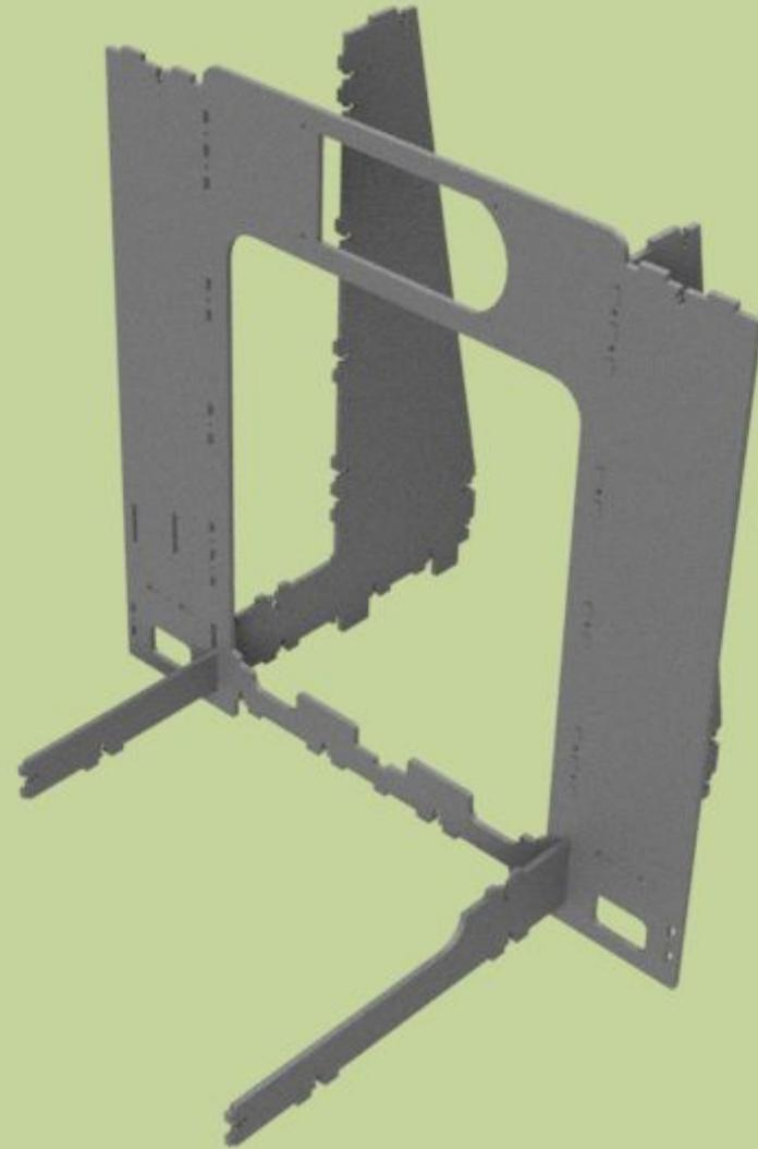
3. Устанавливаем нижнее основание и переднюю пластину.
