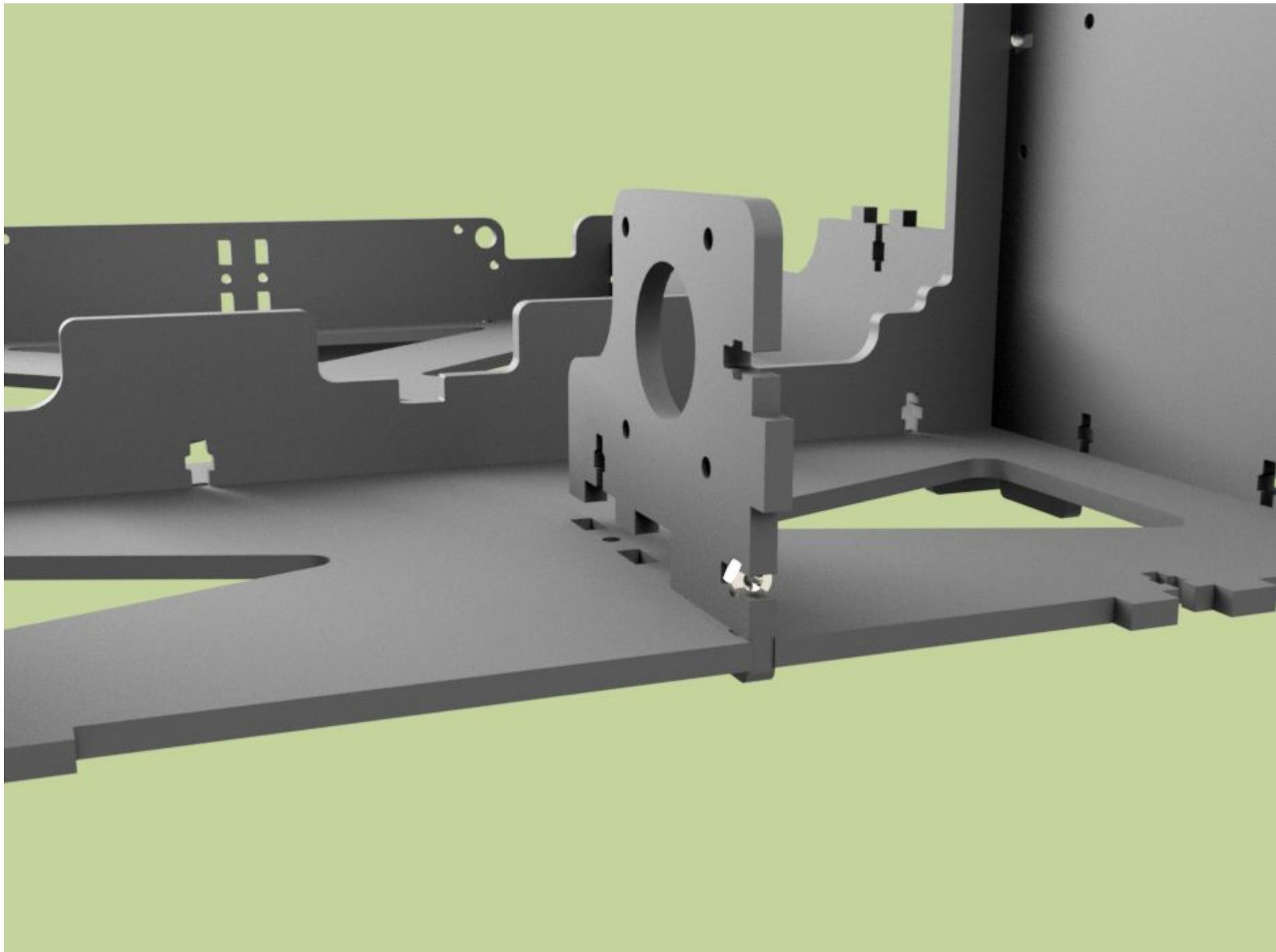
5. Устанавливаем заднюю пластину и крепление концевика Y.
