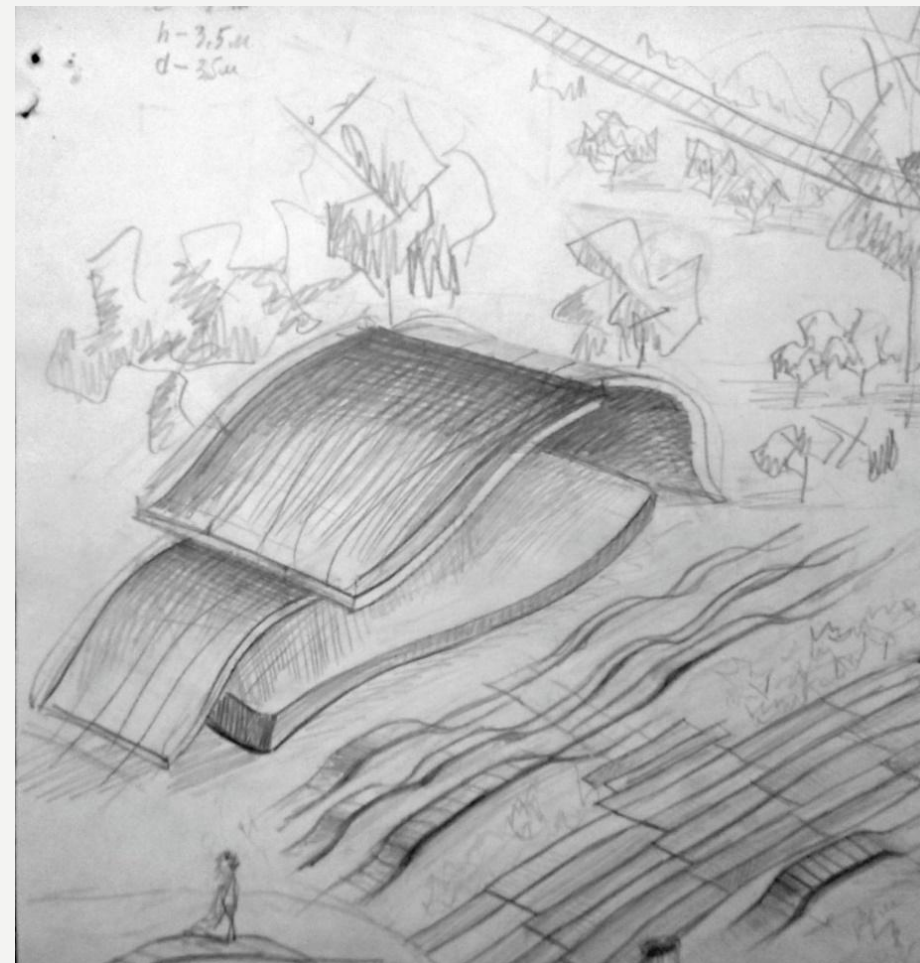
2. Сцена волна. Три листа из гнувшегося пластика, соединенных вместе. Размеры: h (3,5 м) L (7 м) W (3,5 м)
