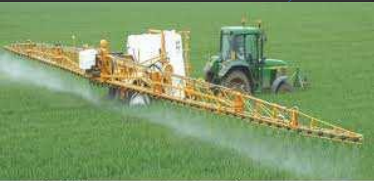
Рис. 9 Проведення позакореневого підживлення рослин штанговим обприскувачем
