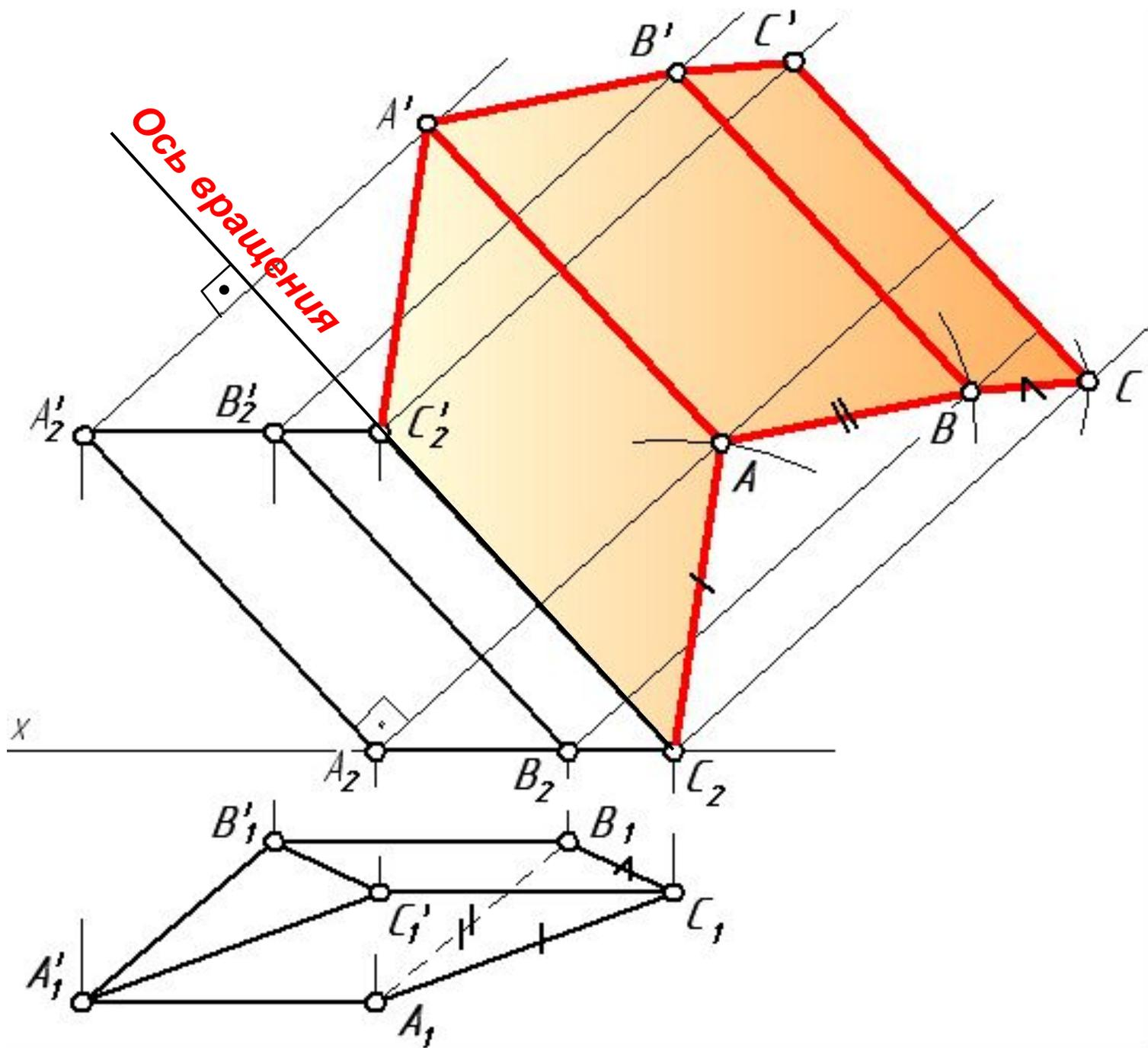
**Построение развертки поверхности наклонной трехгранной призмы способом раскатки.**
