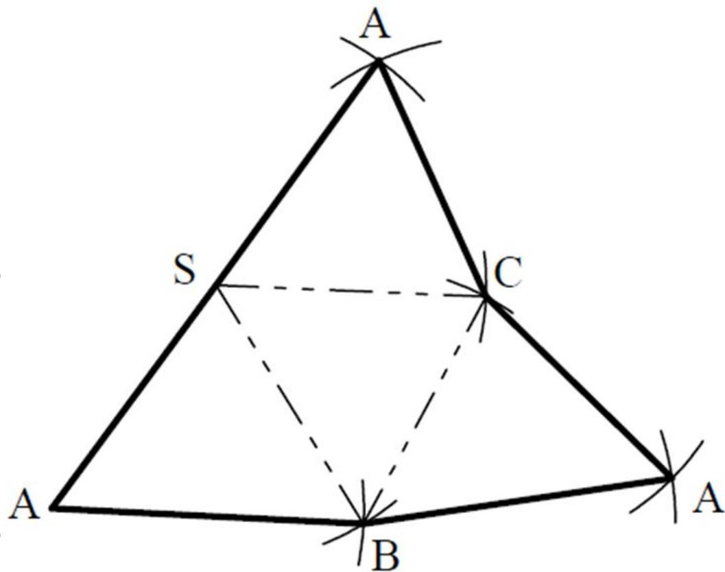
**Для построения развертки конической поверхности применяем метод аппроксимации, т. е. вписываем в эту поверхность или описываем вокруг нее пирамидальную поверхность, причем, чем больше граней, тем точнее получится приближенная развертка.**
