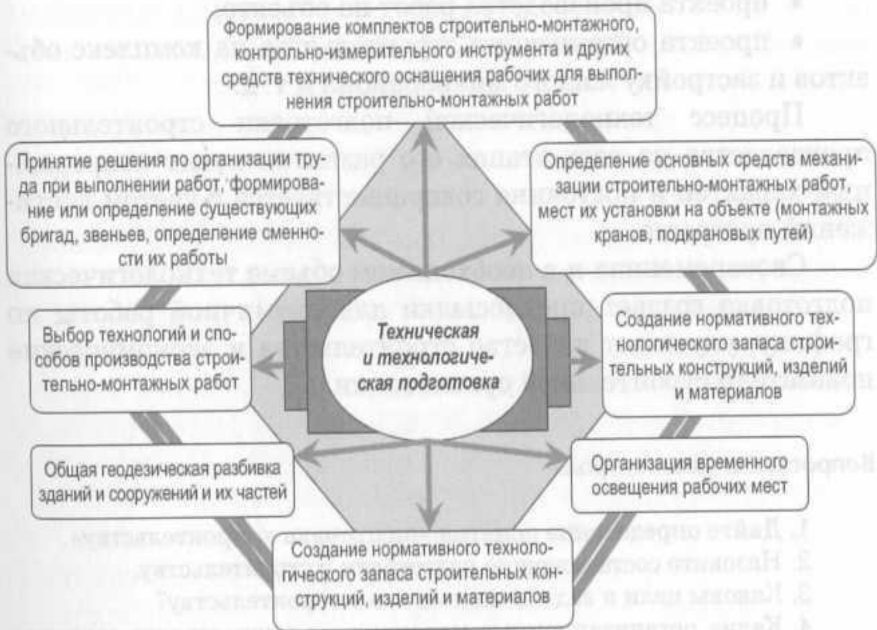
Рис. 3.3. Техническая и технологическая подготовка к строительному производству
