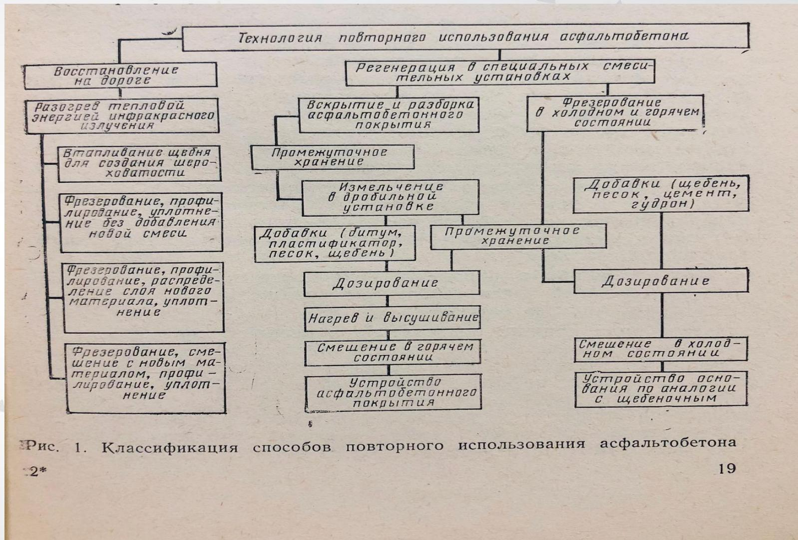
Рис. 1. Классификация способов повторного использования асфальтобетона
