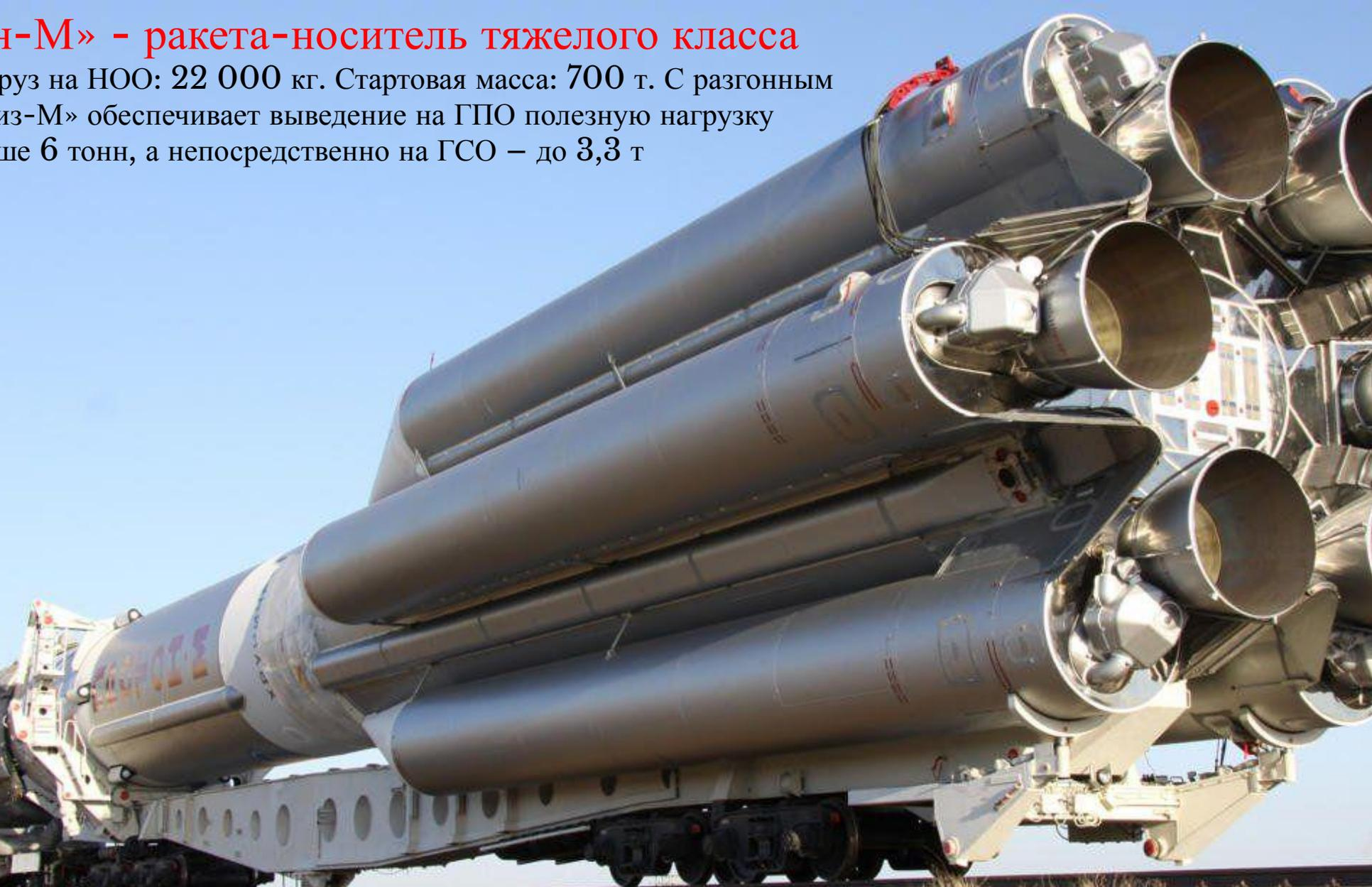
В будущем в Центре Хруничева на базе «Протона-М» перспективную ракету-носитель назовут «Протон-ММ», это будет модификация трехступенчатого «Протона-М». Однако в новой разработке третья ступень будет убрана, что позволит сделать вывод на геопереходную орбиту спутников более экономичным и эффективным.
