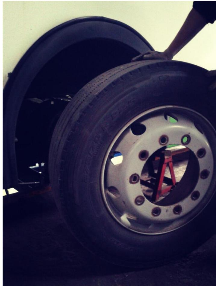
3. Для облегчения снятия тормозного барабана, внутри которого образовалась канавка от действия тормозной накладки, следует утопить фиксатор регулятора тормоза и вращать его ключом влево (против часовой стрелки) до возврата разжимного кулака тормоза в исходное положение, затем ослабить гайки опорных пальцев 9 (см. рис.) колодок и повернуть пальцы метками внутрь. После этого зазор между тормозной накладкой и барабаном станет максимальным.
