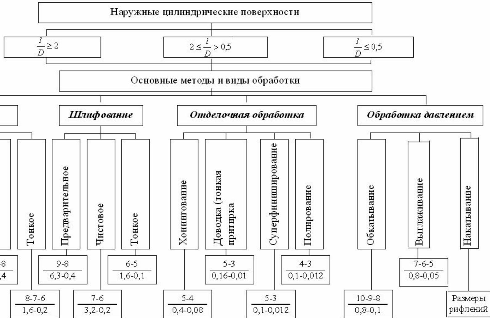
цифры в числителе означают достигаемые качества, в знаменателе – параметр шероховатости  $Ra$ , мкм
