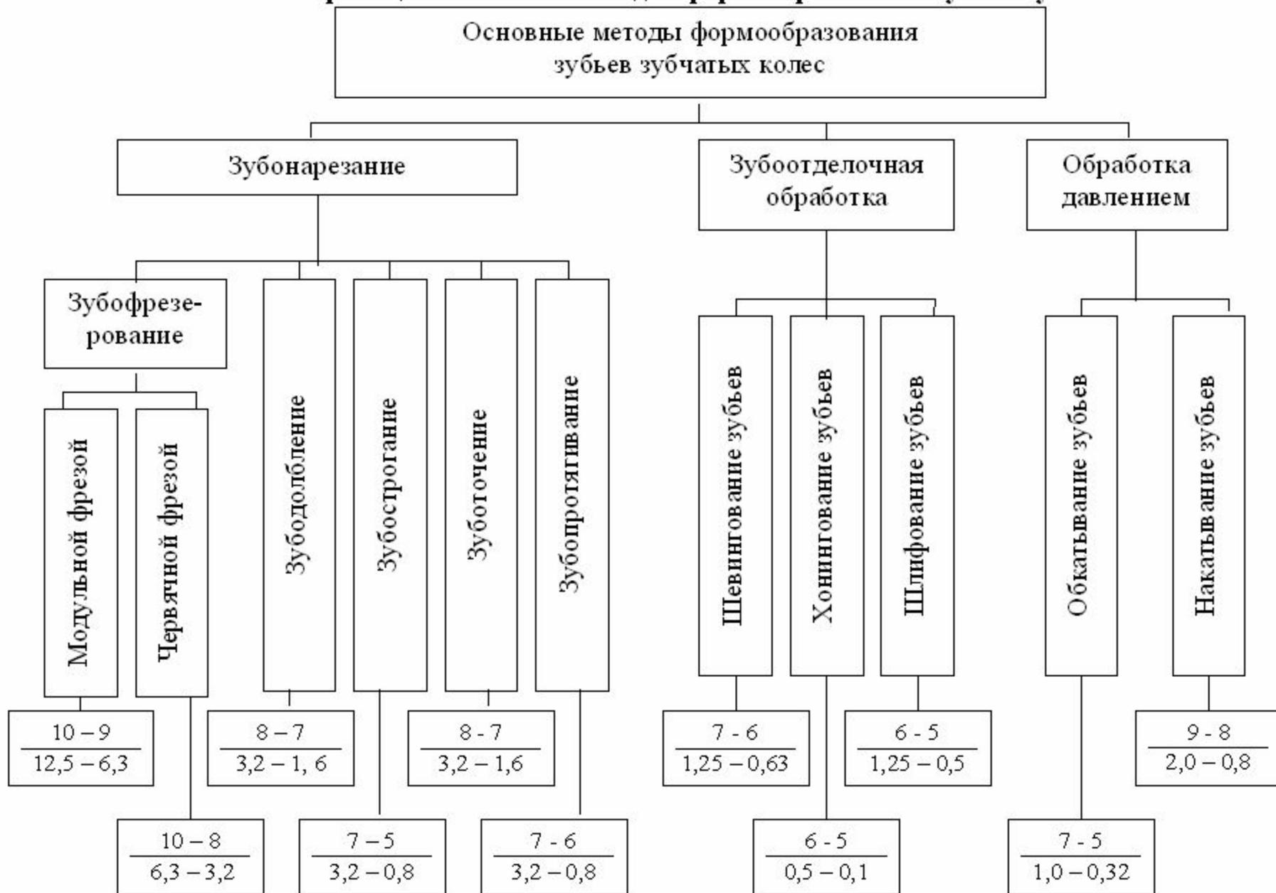
цифры в числителе означают степени точности зубчатых колес, в знаменателе – параметр шероховатости  $Ra$ , мкм
