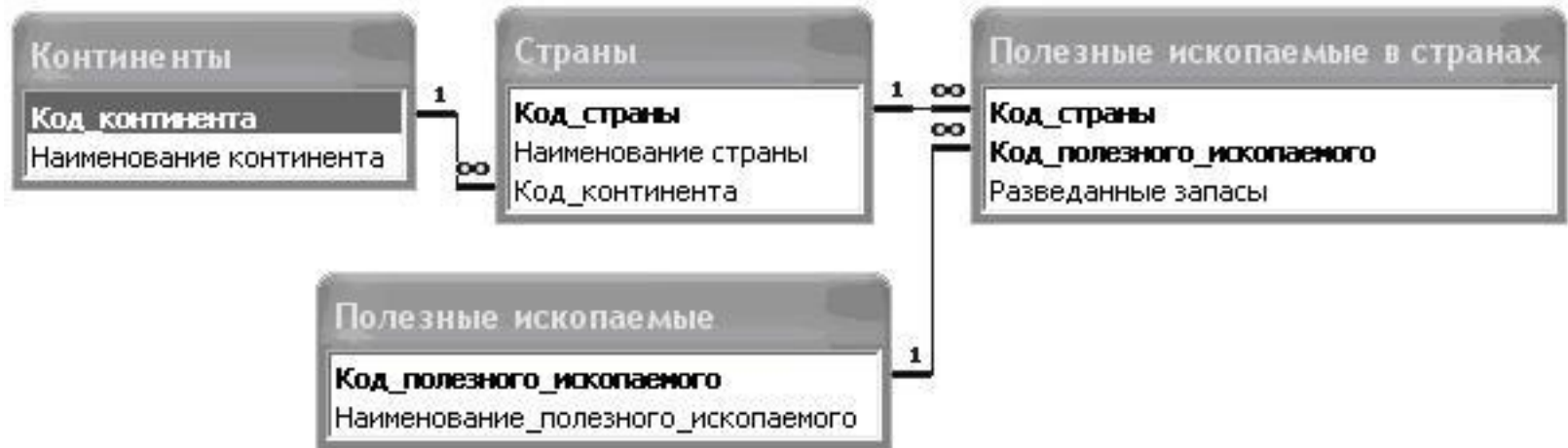
Рис.4. Пример связи ∞:∞ между таблицами «Страны» и «Полезные ископаемые»
