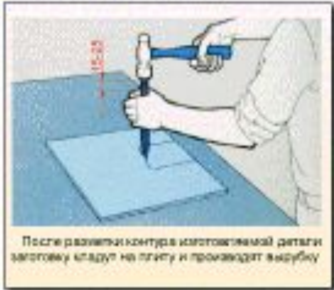
Срубание слоя металла на широкой плоской поверхности
