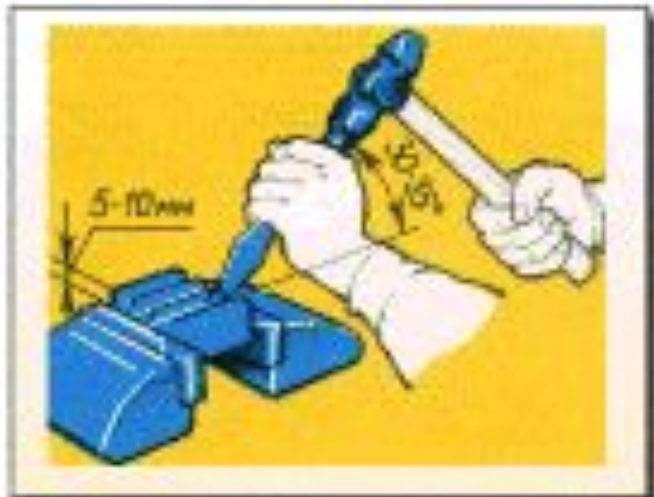
Срубание слоя металла на широкой плоской поверхности
