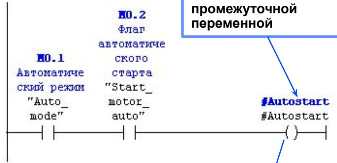
Используем параметр "Autostart" в качестве промежуточной переменной
