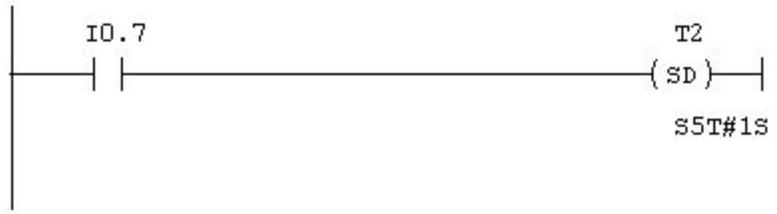
**Network 6:** Опрос битного выхода таймера
