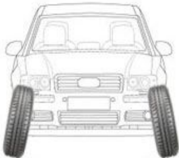
Наклон к кузову отрицательный развал колес
