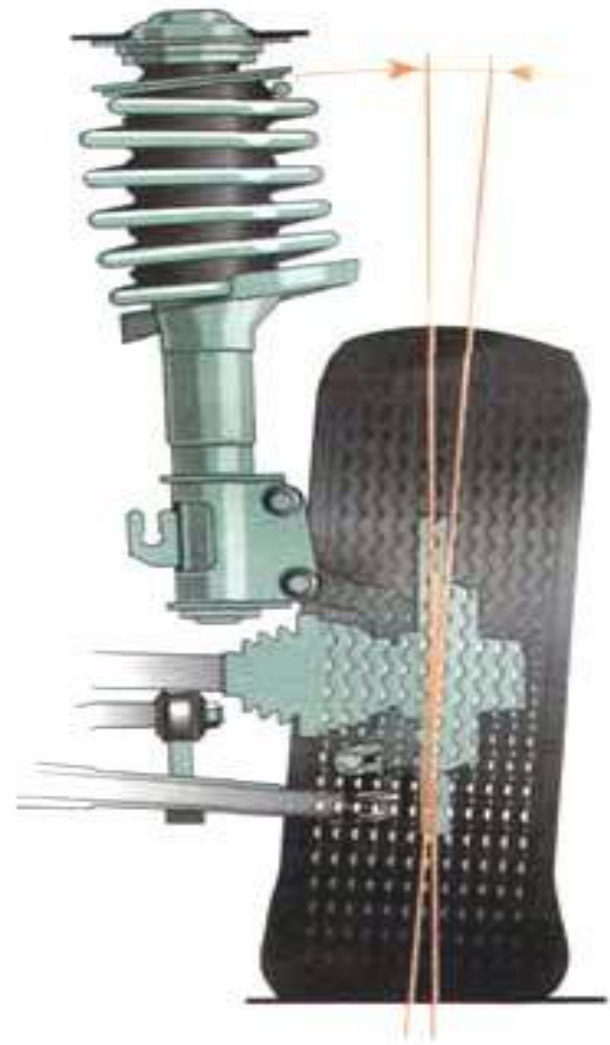
Рис. 2. Угол развала колеса.
