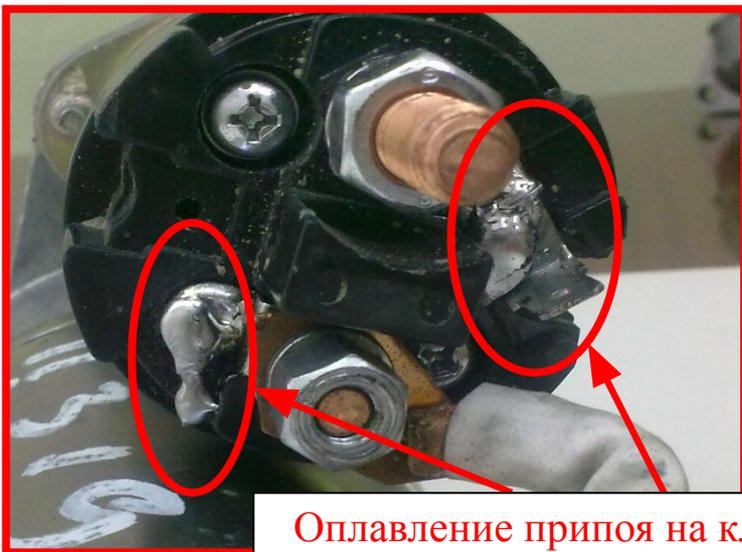
Оплавление припоя на клемме 50 и выводе удерживающей обмотки
