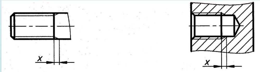
**Недовод резьбы** — величина ненарезанной части поверхности детали между концом сбega и опорной поверхностью детали (при переходе с одного диаметра на другой)
