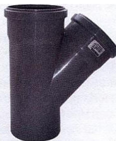
Тройник двухраструбный (угол 45°): D трубы — 40; 50; 110 мм D отвода — 32; 40; 50; 110 мм
