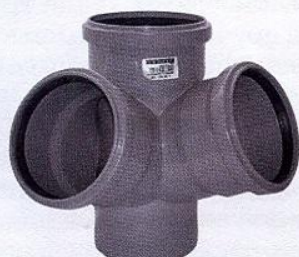
Крестовина двухплоскостная (угол 67, 87°): D трубы — 50; 110 мм D отводов — 50; 110 мм
