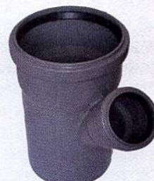
Тройник двухраструбный (угол 67°): D трубы — 40; 50; 110 мм D отвода — 32; 40; 50; 110 мм
